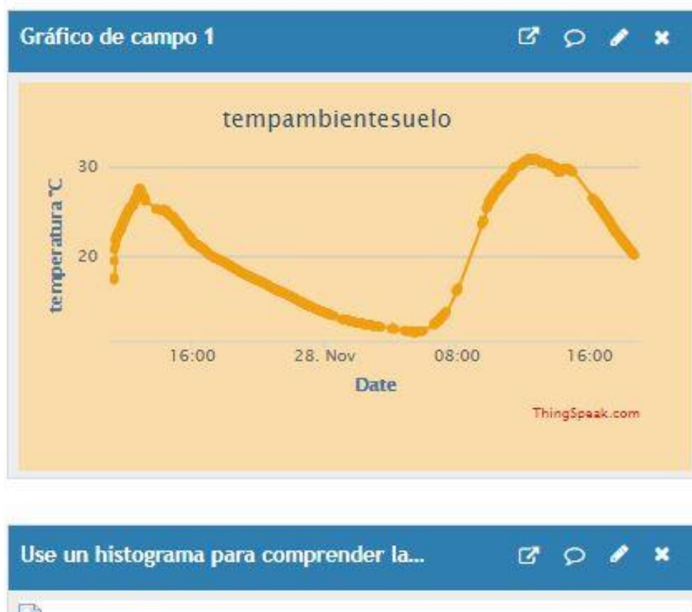
Figura 105: Medición de la Temperatura del suelo Elaboración propia
