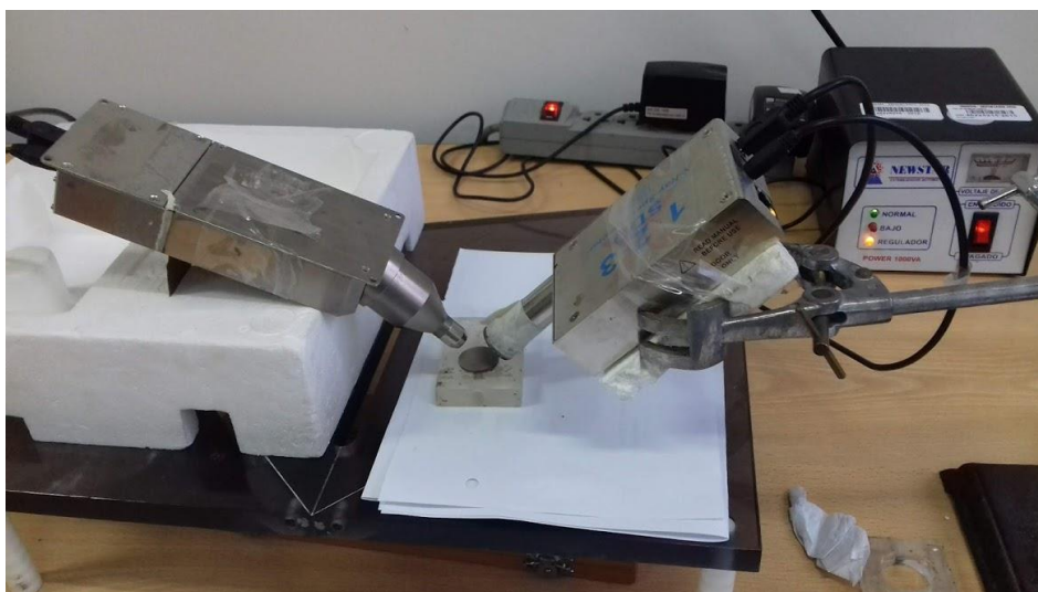
Figura 3.6: Sistema de FRX para la obtención de los espectros (Capturado por el equipo de trabajo)
