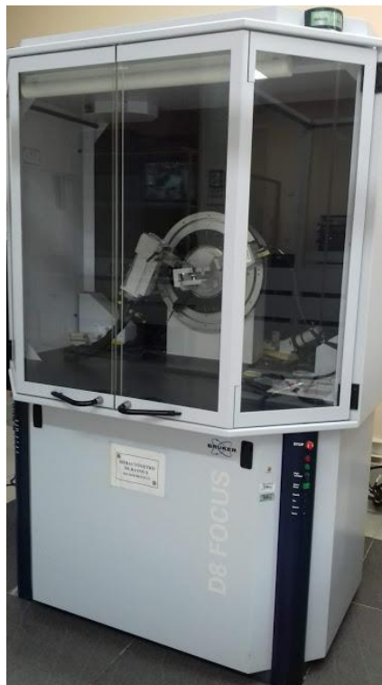
Figura 3.7: Difractómetro de rayos X BRUKER AXS modelo D8 Focus (UNMSM) (Capturado por el equipo de trabajo)
