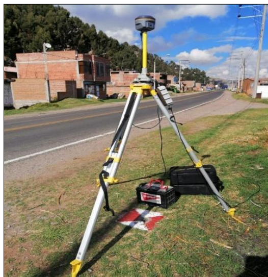
Figura N° 27: Estación de GPS en el punto de apoyo TESIS 01
