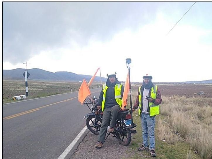
Figura N° 30: Receptor GNSS – Rover acondicionado a la moto lineal
