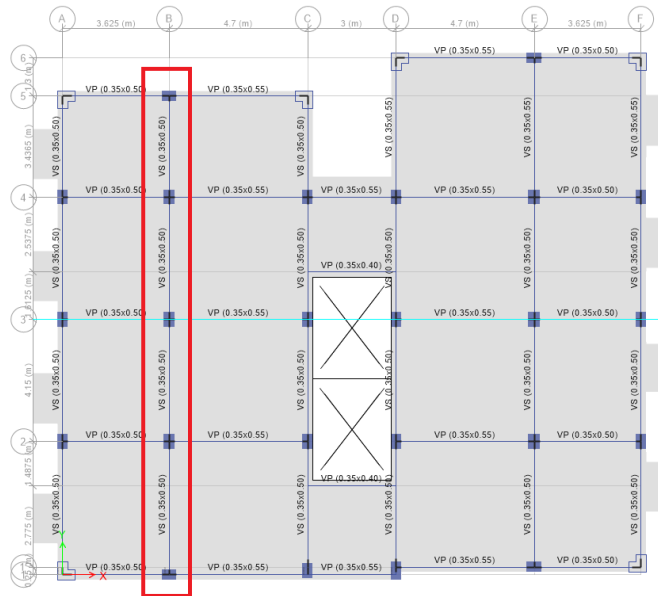
Figura 3.24 Pórtico donde se muestran las vigas a diseñar. Fuente: Tomado del ETABS 2016.
