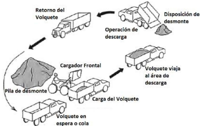
**Figura 9.** Eliminación de desmonte de obra, ejemplo de actividad repetitiva.
