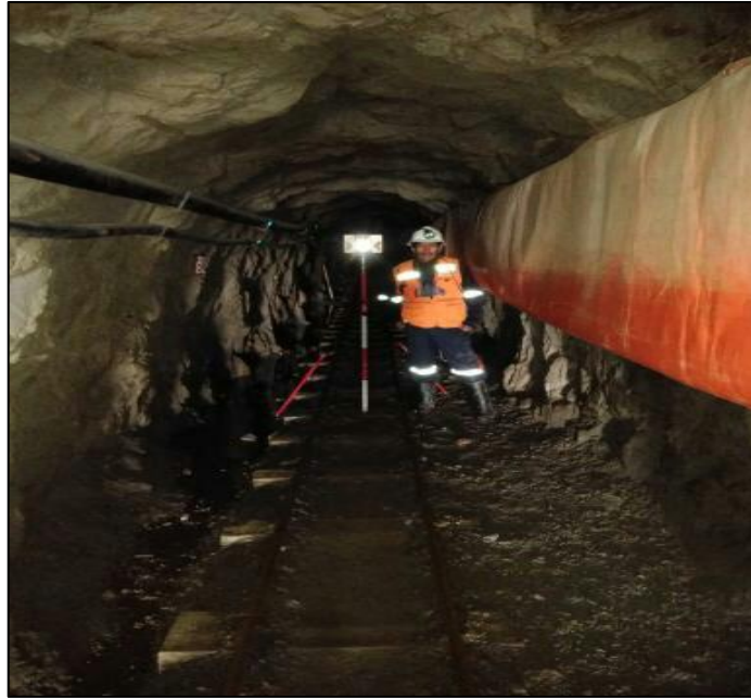
Figura 55. Estacionamiento de bípode en el interior
