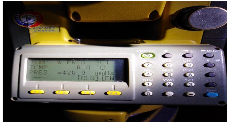
Figura 53. Configuración equipo estación total
