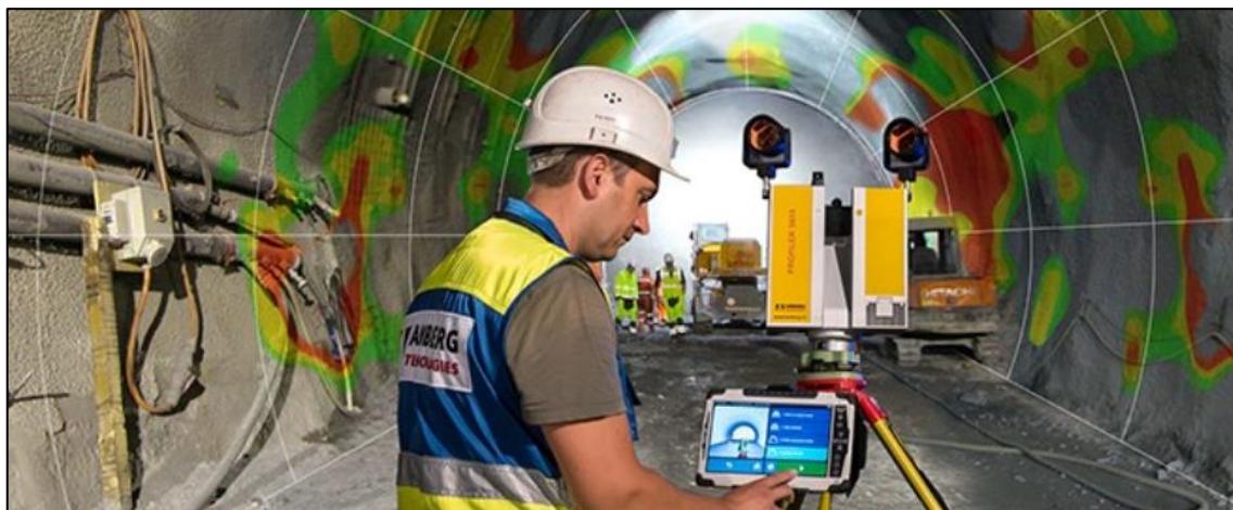
Figura 67. Laser escáner terrestre especial para labor subterránea
