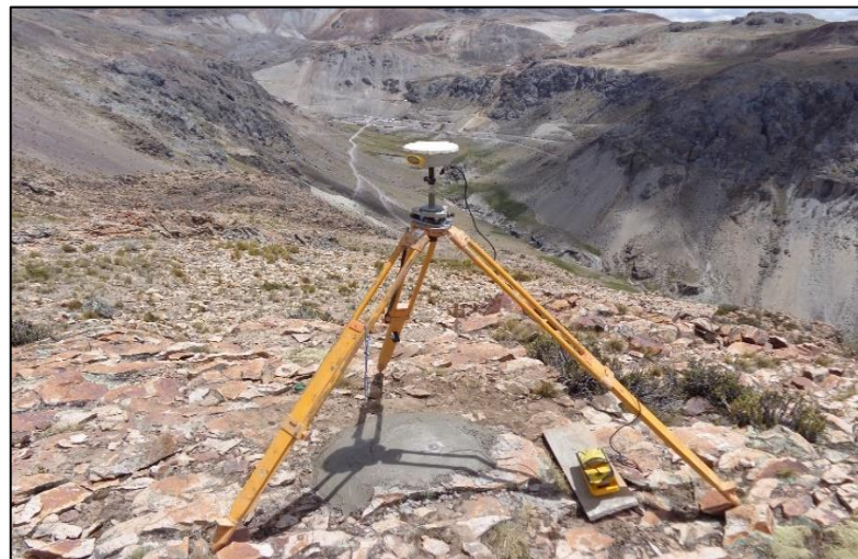
Figura 45. Posicionamiento GPS estático punto base E-1
