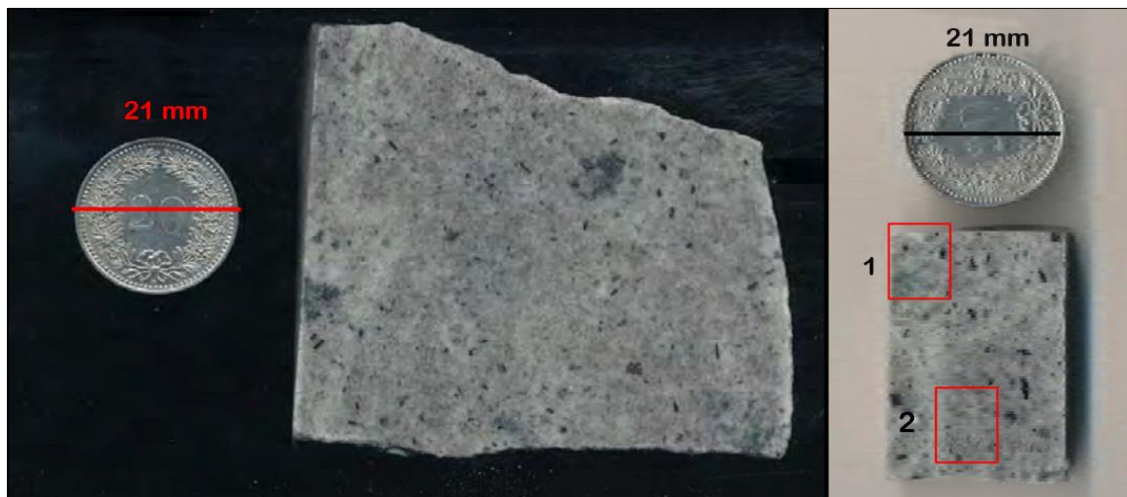
Figura N° 39: Muestra SR-3610-02, muestra de mano (izquierda) y losa utilizada para obtener una sección delgada (derecha).
