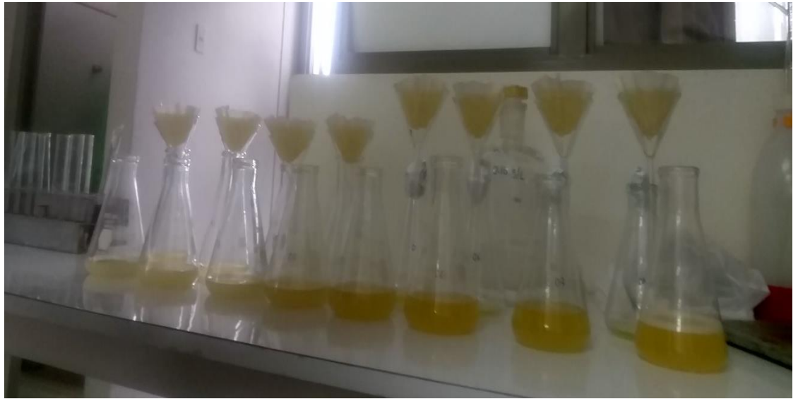
Fotografía B. 9: Remoción de la saponina con óxido de titanio/peróxido de hidrogeno/sulfato ferroso ( \text{TiO}_2/\text{H}_2\text{O}_2/\text{FeSO}_4 ).
