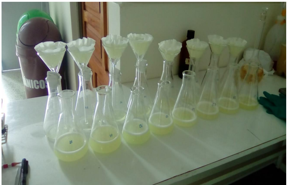
Fotografía B. 8: Remoción de la saponina con óxido de titanio y peróxido de hidrogeno ( \text{TiO}_2/\text{H}_2\text{O}_2 ).
