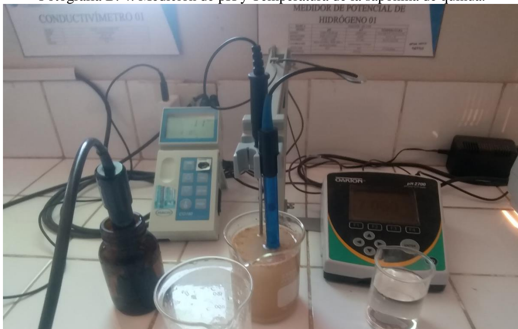
Fotografía B. 4: Medición de pH y Temperatura de la saponina de quinua.
