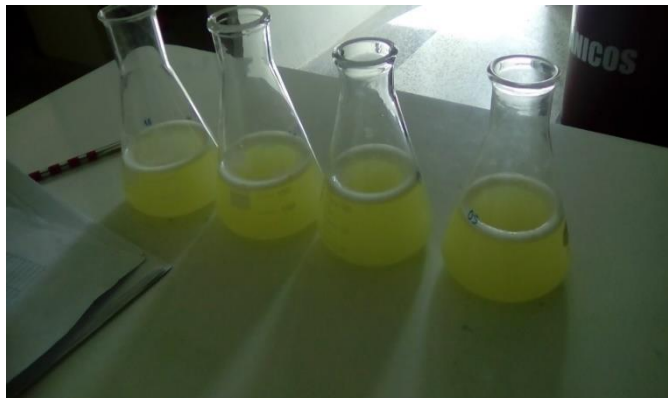
Fotografía B. 10: Remoción de la Saponina con óxido de titanio/peróxido de Hidrogeno/sulfato ferroso/radiación UV ( \text{TiO}_2/\text{H}_2\text{O}_2/\text{FeSO}_4/\text{UV} ).
