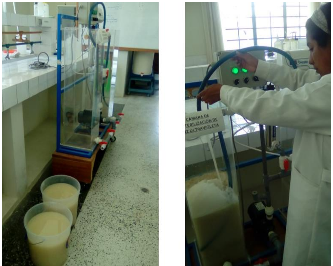
Fotografía B. 14: Remoción de la saponina con óxido de titanio/peróxido de hidrogeno/sulfato ferroso/radiación UV (TiO 2 /H 2 O 2 /FeSO 4 /UV).
