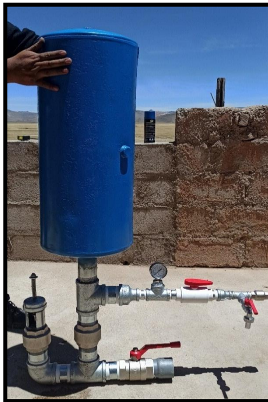
Figura 57: Bomba de ariete hidráulico de 2 pulgadas.
