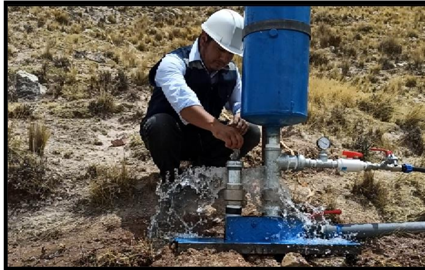
Figura 65: Calibración de la carrera del vástago.
