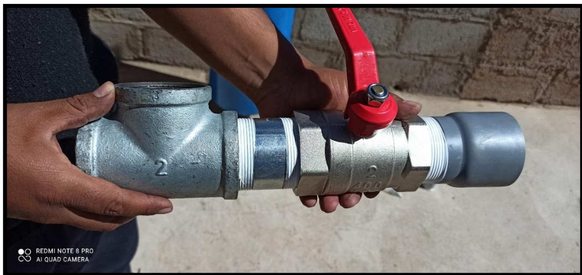
Figura 45: Montaje de los componentes de cuerpo de la bomba de ariete hidráulico
