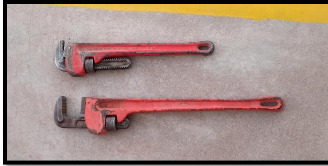
Figura 56: Llaves stillson para el apriete de la bomba de ariete hidráulico.
