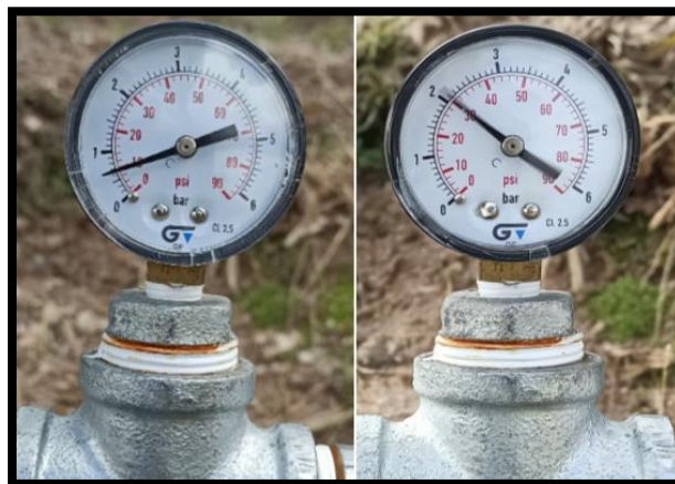
Figura 69: Medición de presiones en el manómetro.
