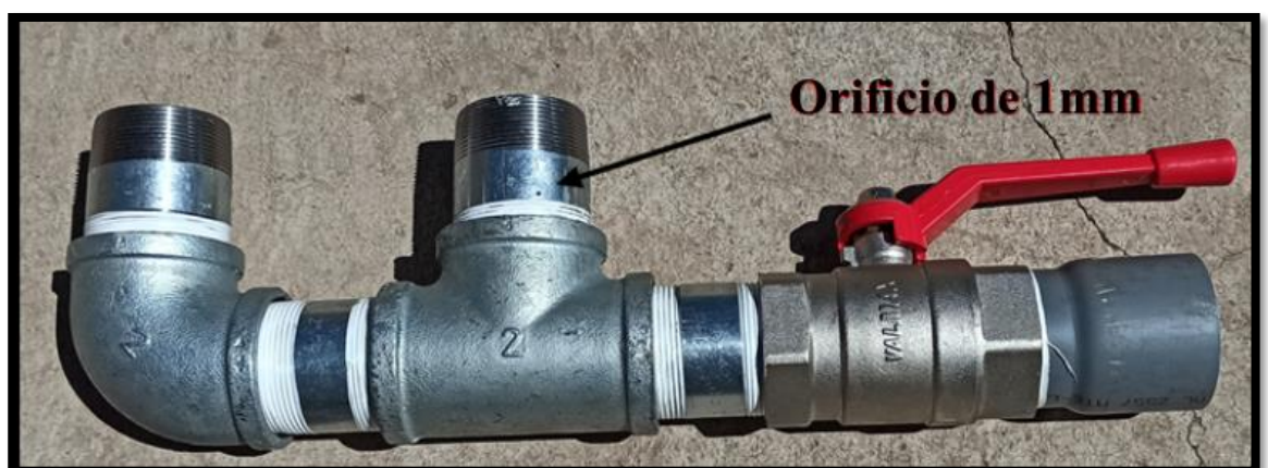
Figura 47: Cuerpo de la bomba de ariete con orificio de 1mm.
