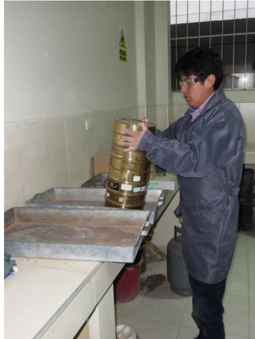
Figura 3.12: Tamizado agregado grueso.
