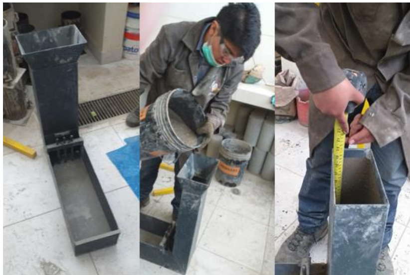
Figura 3.31: Ensayo Caja L.
