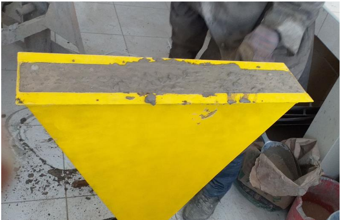
Figura 08: Terminado de llenado de embudo “V” con concreto autocompactante.
