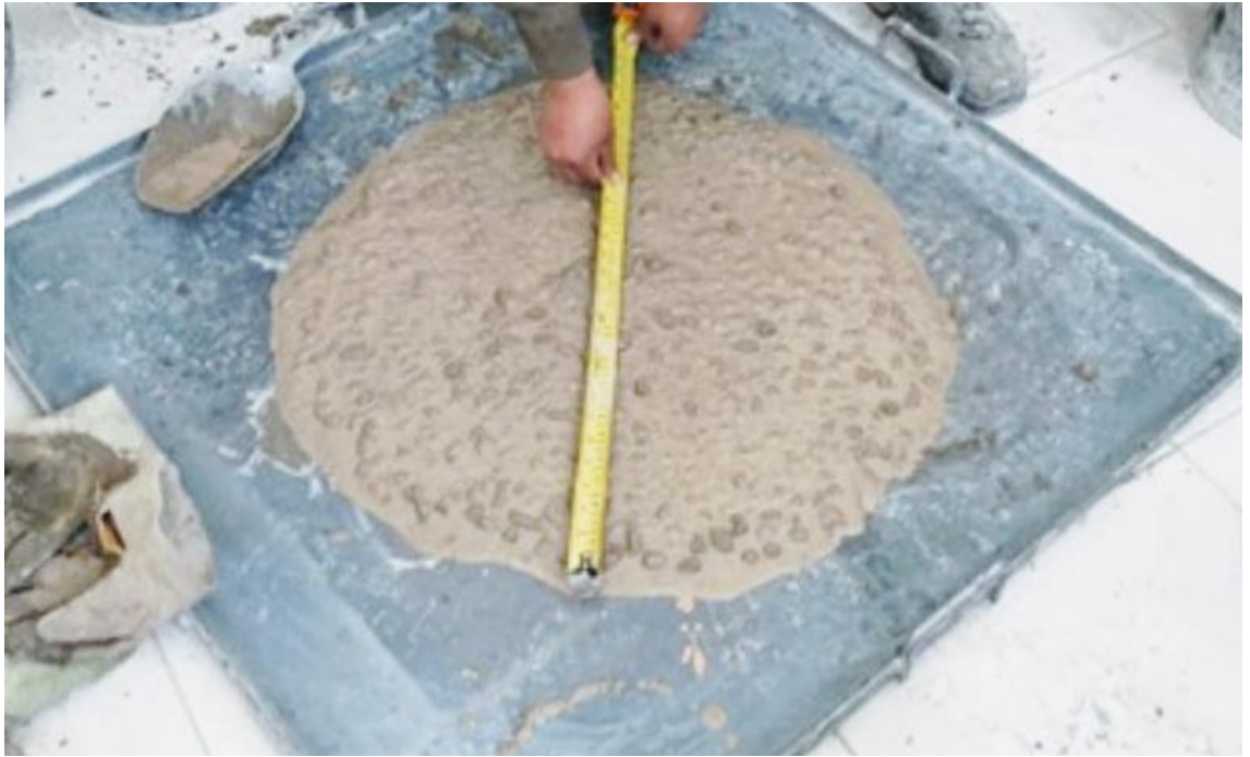
Figura 03: Midiendo la extensión del escurrimiento del concreto autocompactante.
