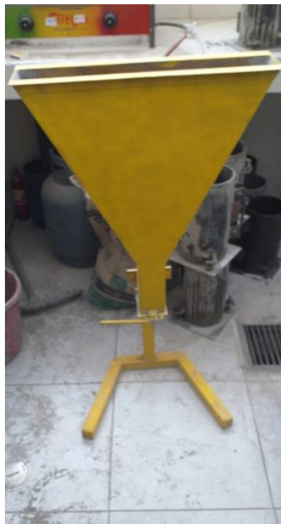
Figura 3.29: Equipo Embudo en V.
