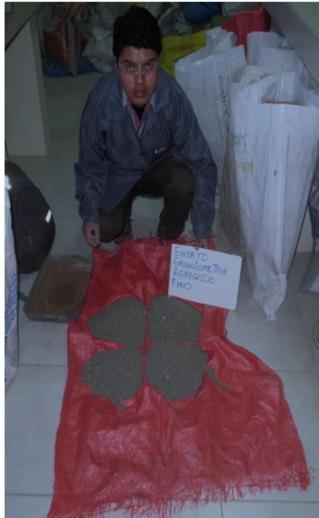
Figura 3.2: Cuarteo del agregado fino
