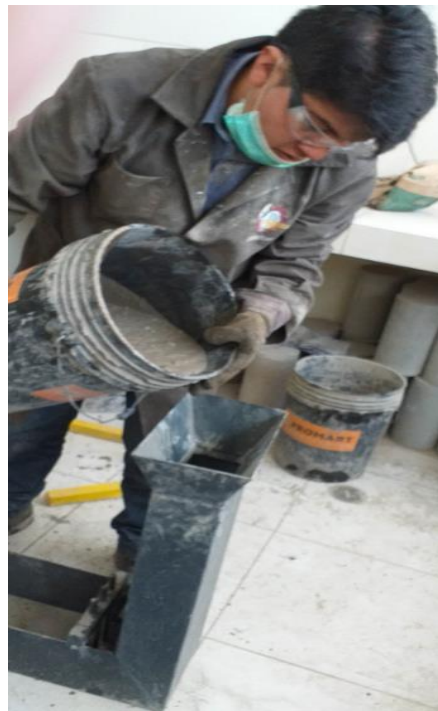
Figura 04: Vaciado de concreto autocompactante en compartimiento vertical de la caja L
