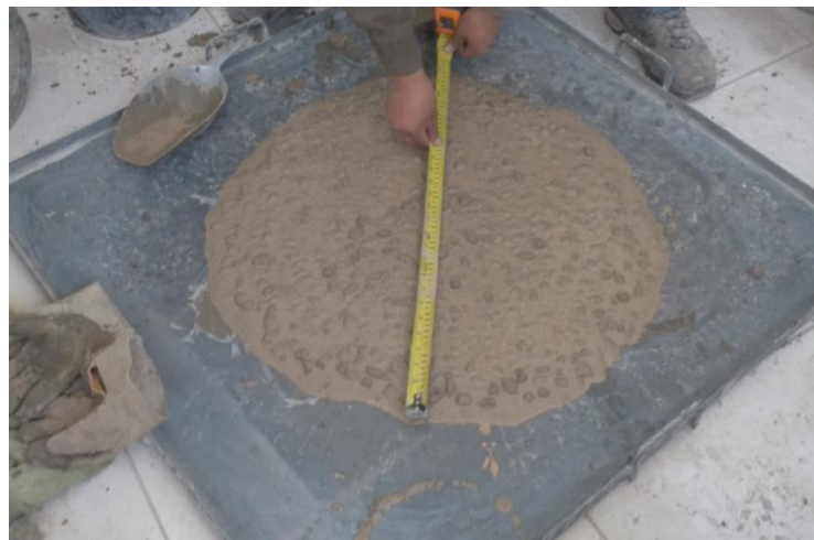
Figura 3.28: Medición del diámetro alcanzado.
