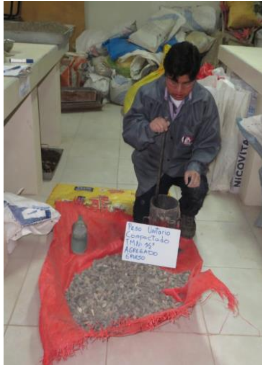
Figura 3.14: Apisonado del agregado grueso por capas.
