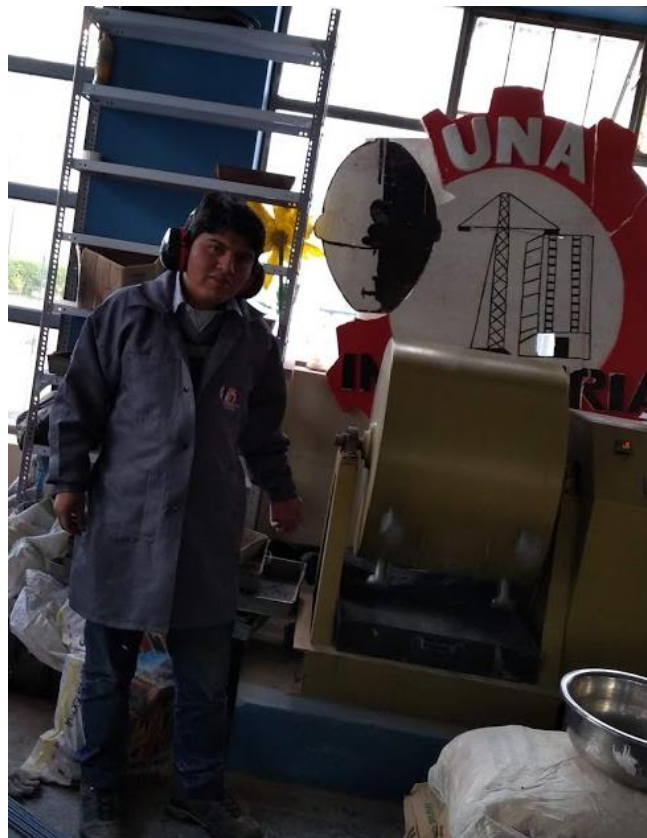
Figura 3.15: Ensayo de Abrasión de Los Ángeles.
