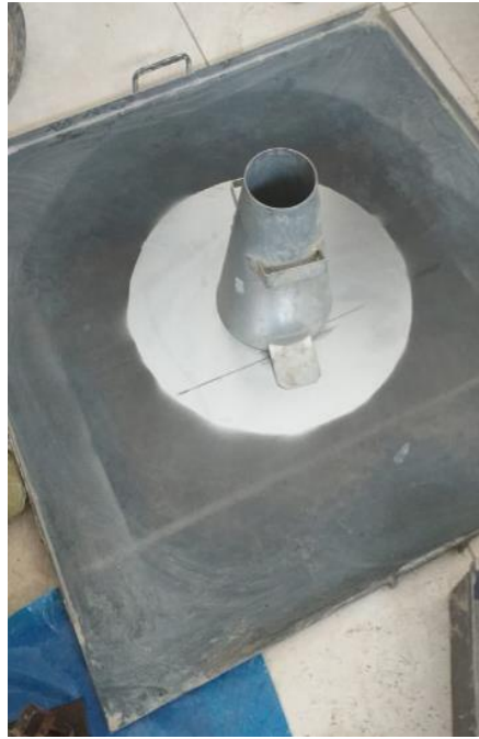
Figura 3.27: Equipo ensayo de escurrimiento.
