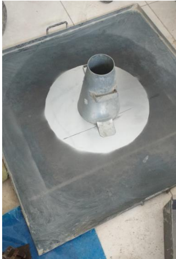
Figura 01: Bandeja de 1 metro por 1 metro con el cono de Abrams.
