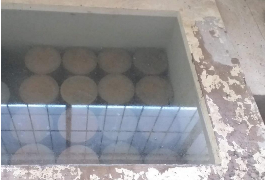
Figura 3.25: Curado de Probetas a temperatura ambiente.
