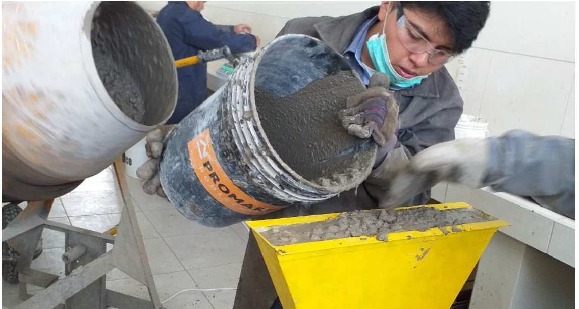
Figura 07: Vaciado de concreto autocompactante en compartimiento vertical del embudo “V”.
