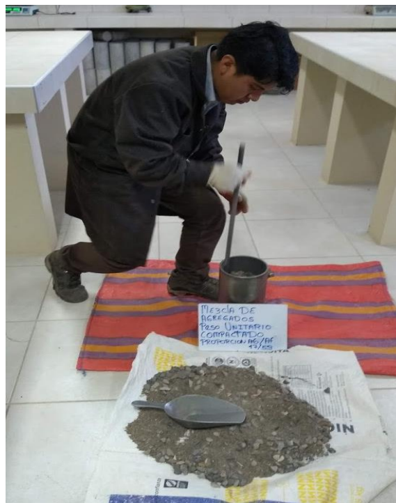
Figura 3.21: Apisonado de la mezcla de agregados.
