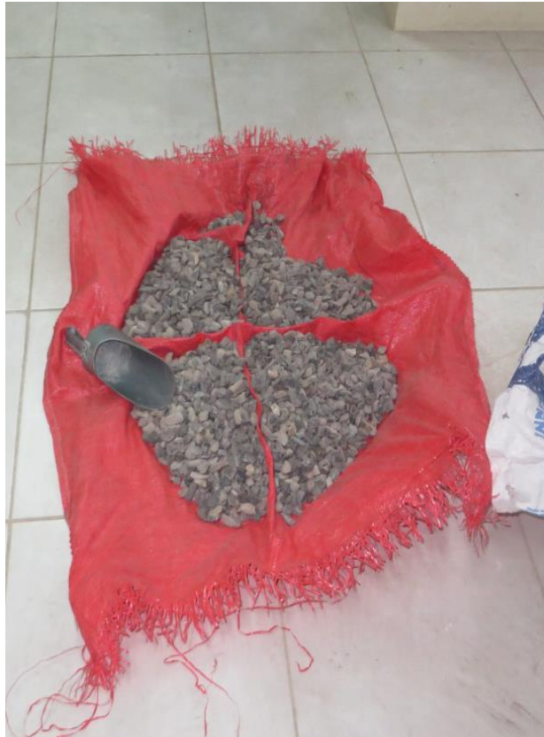
Figura 3.11: Cuarteo del agregado grueso.
