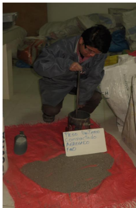
Figura 3.7: Apisonado del agregado fino por capas
