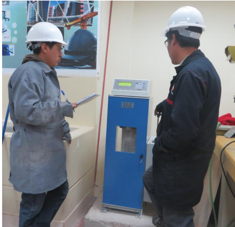
Figura 3.32: Ensayo de resistencia a compresión.
