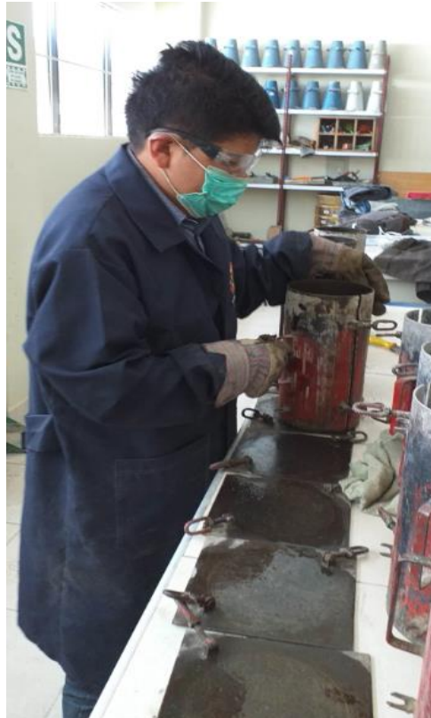
Figura 3.23: Embadurnamiento de moldes metálicos.
