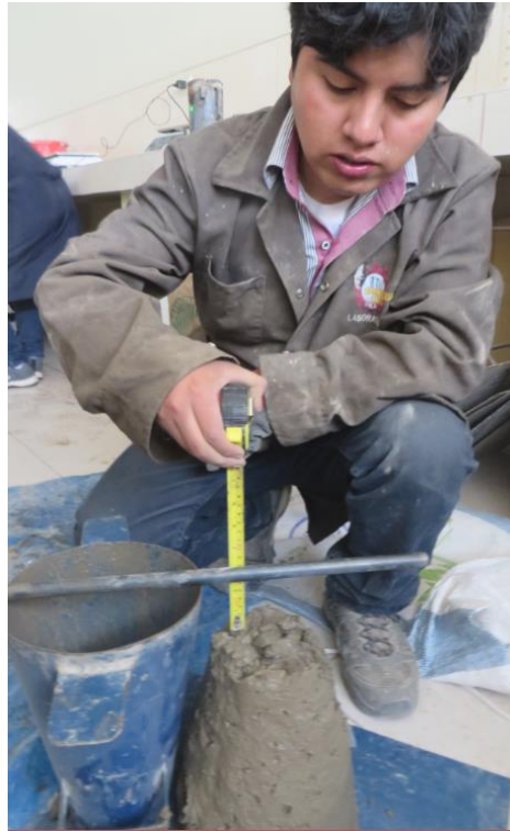
Figura 3.26: Ensayo de asentamiento cono de Abrams.
