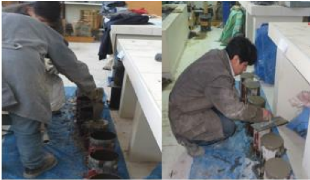
Figura 3.24: Vaciado en moldes metálicos.
