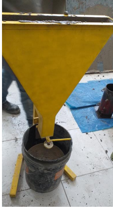
Figura 09: Se determinó el tiempo que tarda en pasar el concreto autocompactante por la abertura estrecha del embudo.
