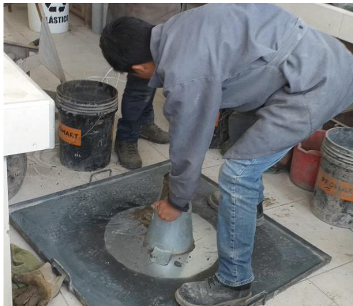
Figura 02: Realizando el ensayo de escurrimiento en bandeja de 1 metro por 1 metro con el cono de Abrams.
