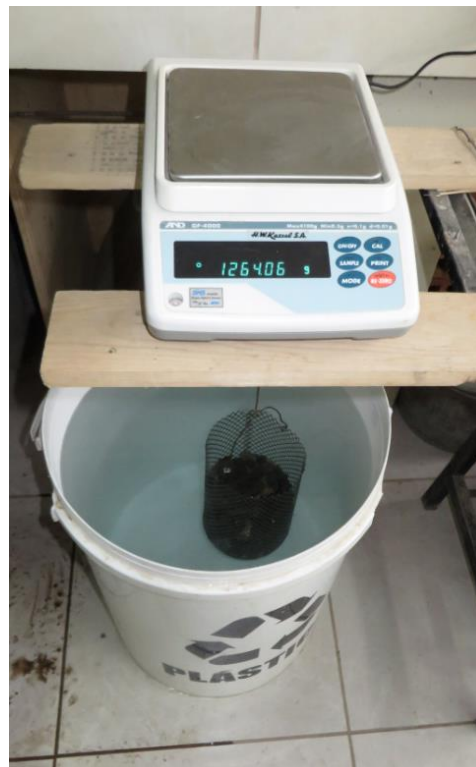
Figura 3.13: Peso de la canastilla con agregado grueso sumergido en agua.
