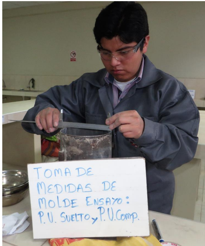
Figura 3.5: Medición de las dimensiones del molde cilíndrico
