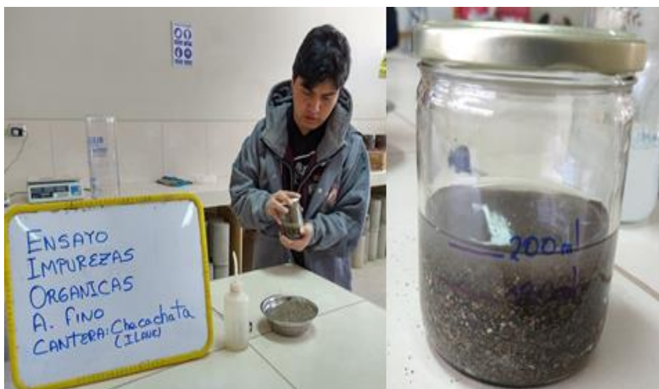
Figura 3.8: Ensayo impurezas orgánicas.
