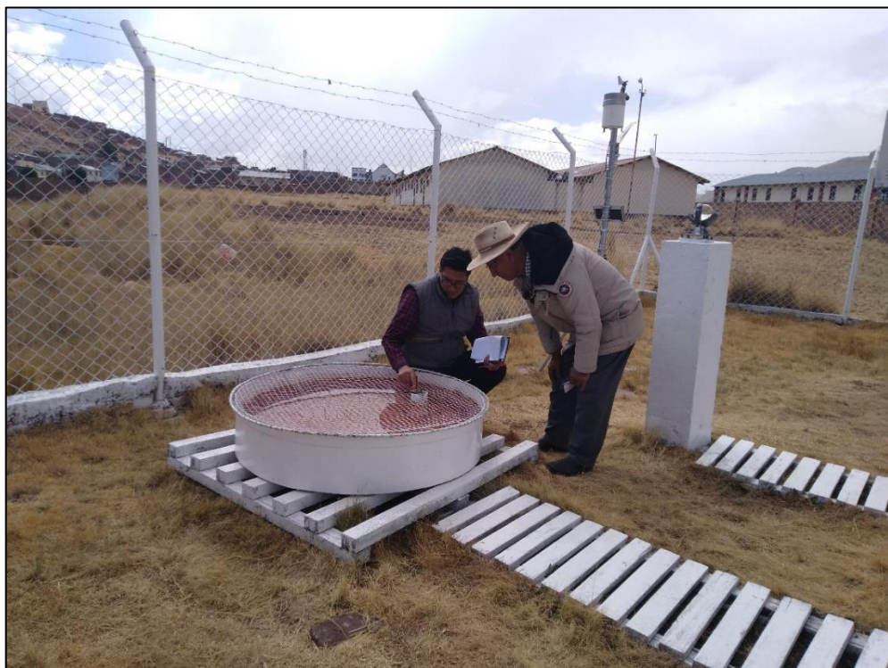
Estación Meteorológica Huancané - Tanque evaporímetro tipo A
