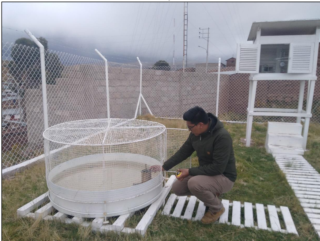
Estación Meteorológica Muñani - Tanque evaporímetro tipo A.
