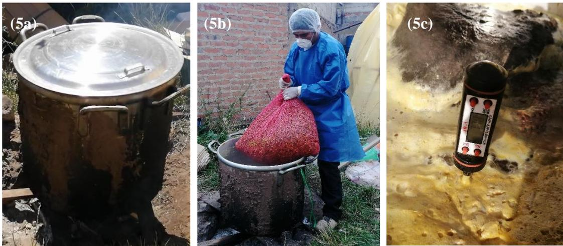
(5a) Olla galvanizada de 80 litros en proceso de calentamiento. (5b) Sumersión de los residuos lignocelulosicos (5c) Termometro alcanzando los 77.5 °C
