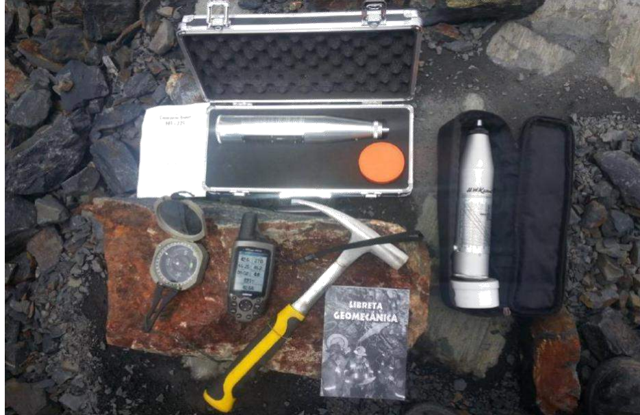
Foto 03: Instrumentos que se utilizaron para la caracterización geomecánica en interior Mina
