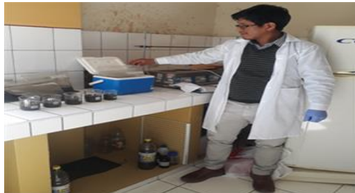
IMAGEN N° 05. Muestras de lodos trasvasados en vasos precipitados rotulados de capacidad de 100 mL, para posterior pesado y secado.
