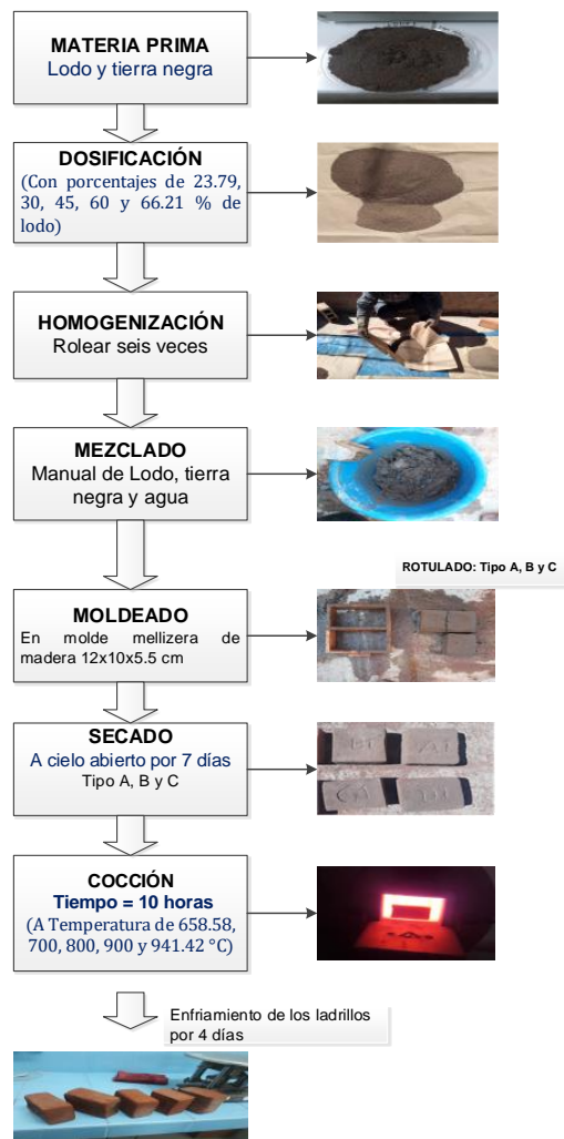
Figura 24. Diagrama de flujo del proceso de elaboración del ladrillo a partir de lodo
