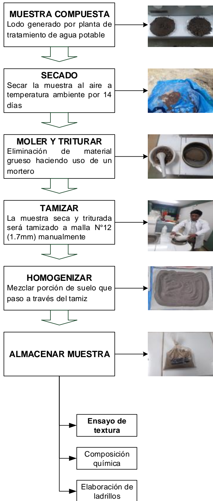
Figura 18. Diagrama de flujo del tratamiento físico del lodo
