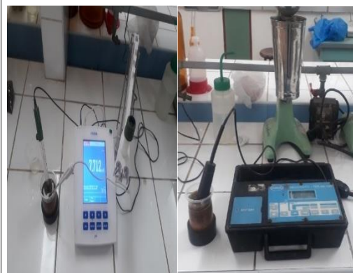
IMAGEN N° 04. Análisis de pH, temperatura y conductividad a las cinco muestras puntuales de lodo.
