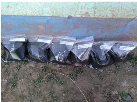
IMAGEN N° 03. Muestras puntuales de lodo en bolsa zifloc rotulados como: M-1, M-2, M-3, M-4 y M-5. Y Composito de muestras puntuales con el nombre de "LODO", para análisis en laboratorio.
