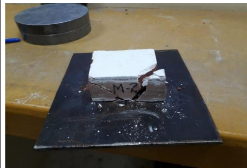
IMAGEN N° 24. Se observa rotura de la muestra de ladrillo después de haber sido sometido con una carga, para posterior a ello calcular la resistencia a la compresión.
