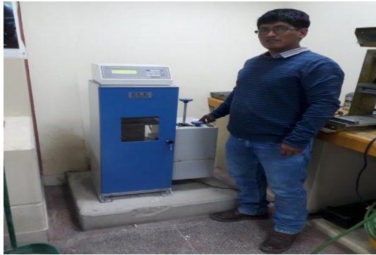
IMAGEN N° 21. Tesista junto al equipo de prensa digital de rotura de marca ELE de 2501112 kN, en Laboratorio de Construcciones.
