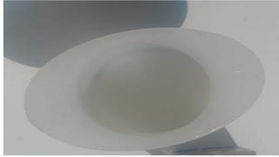
*Figura 8 Molde para la elaboración de secciones delgadas con curación y pulidas*
