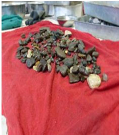
*Figura 20 Ensayo de chatas y alargadas de los agregados*
