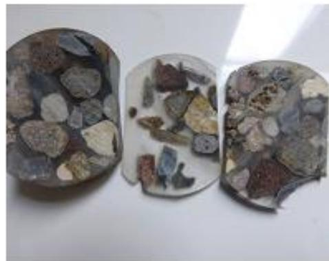
Muestra para ensayo petrográfico
