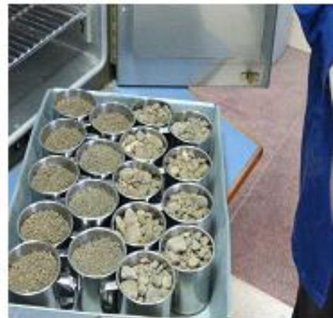
Ensayo de contenido de humedad
