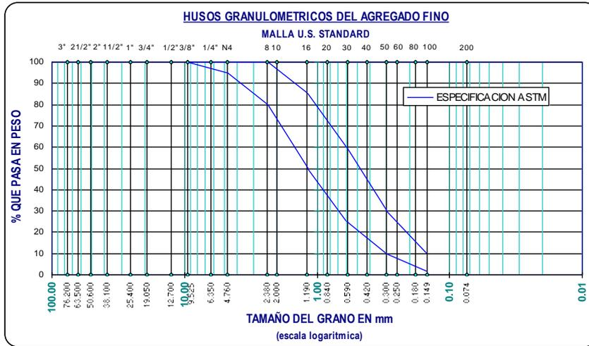
Figura 1 Huso granulométrico del agregado fino
