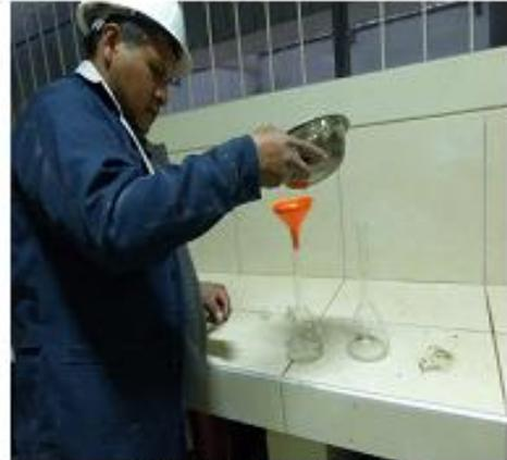
Ensayo de peso específico
