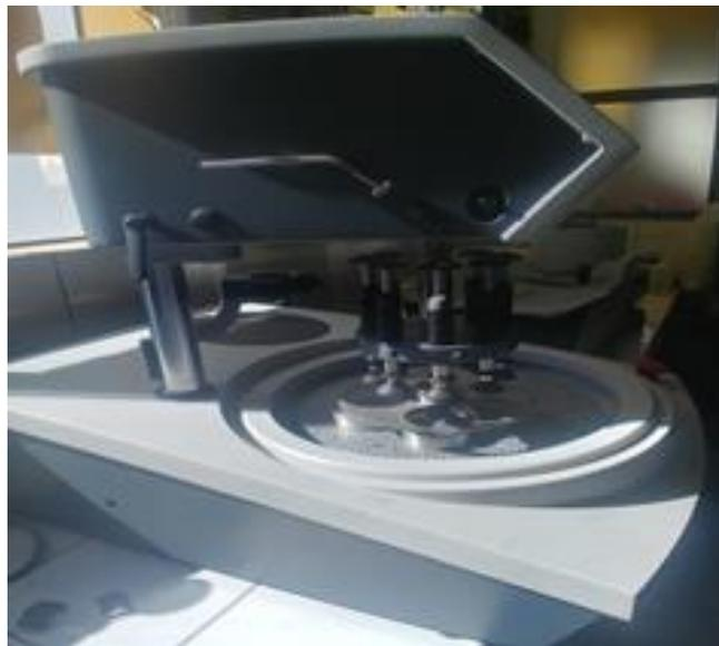
*Figura 11 Desbastadora y pulidora de secciones delgadas y pulidas, marca Struers*
