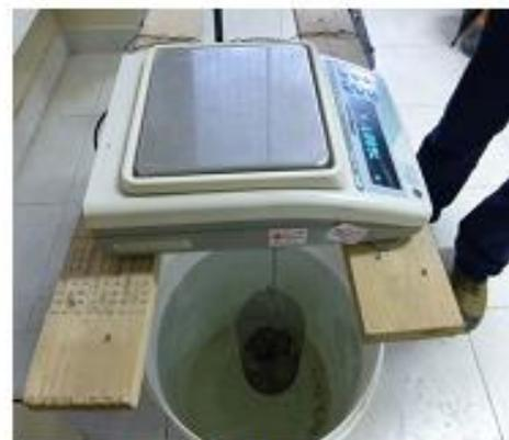
Ensayo de peso específico
