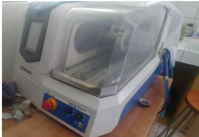
*Figura 9 Cortadora de muestras semiautomático para la elaboración de secciones delgadas y pulidas*
