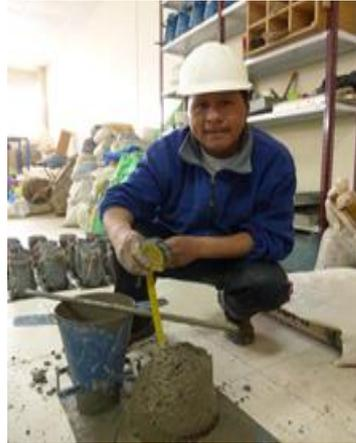
*Figura 27 Ensayo de asentamiento de la mezcla de concreto*
