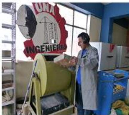
Ensayo de abrasión
