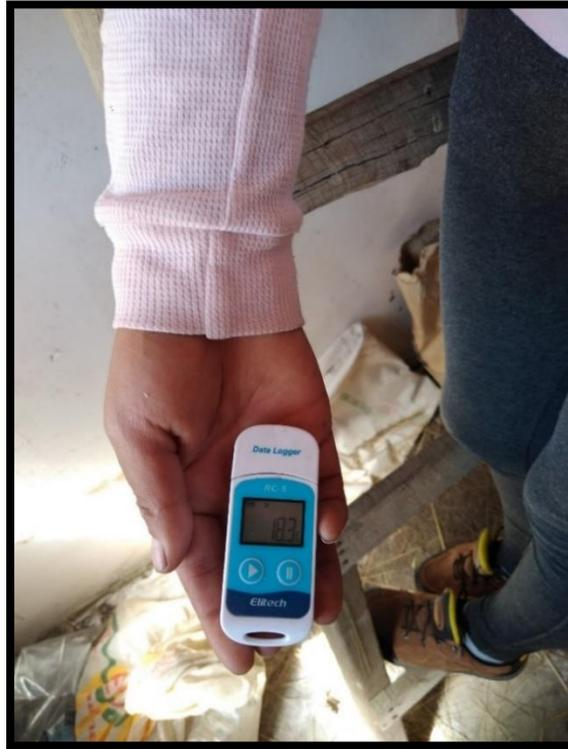
*Figura 49: Lectura de temperatura en vivienda construida con stipa ichu.*
