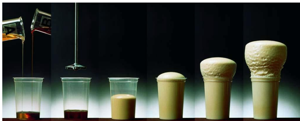
Figura N° 39: En los sistemas de proyección, la reacción se completa en unos 10 segundos. Fuente: (ATEPA - Asociación Técnica del Poliuretano Aplicado, 2012)
