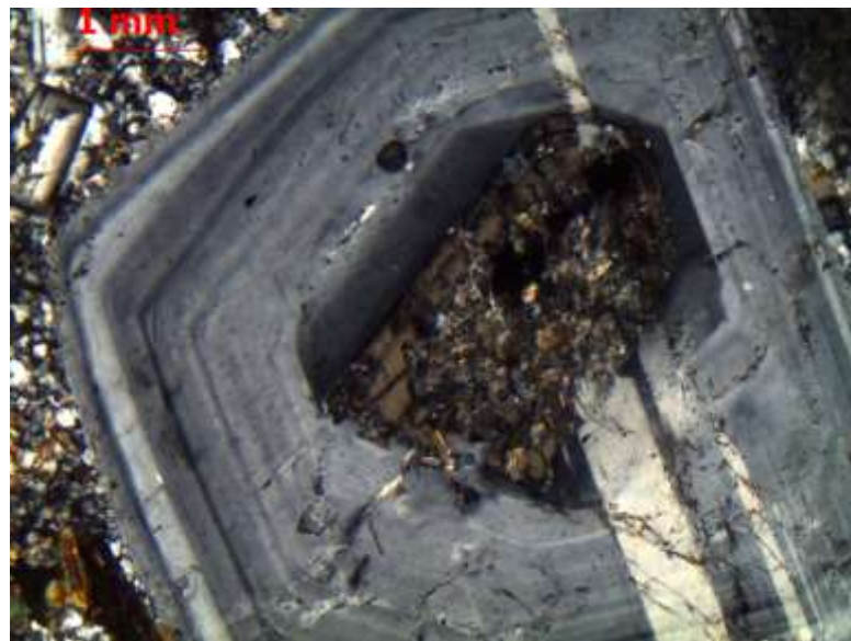
Figura 11. Fenocristal idiomorfo de oligoclasa, con una exfoliación perfecta, visto en luz polarizada, 20x.
