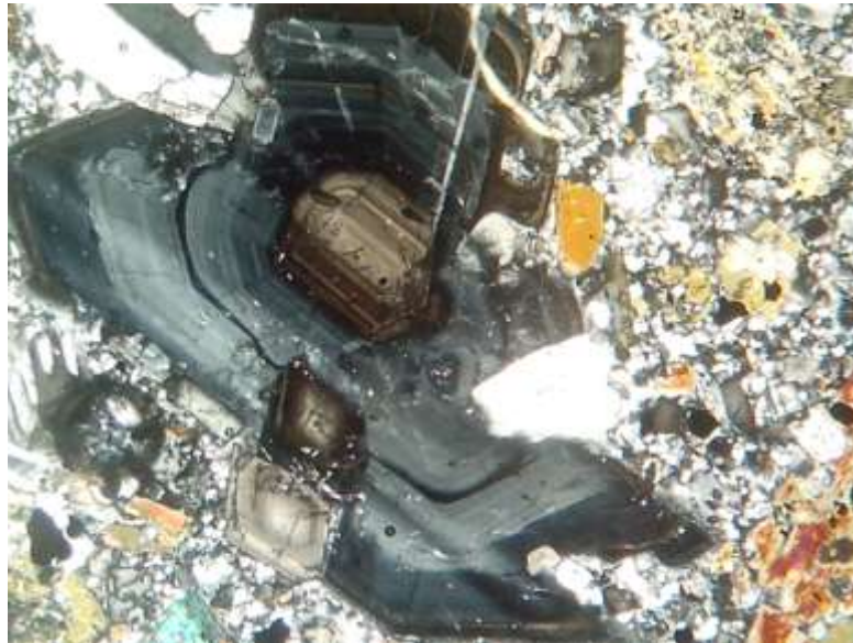
Figura 22. Cristal idiomorfo de plagioclasa, con una exfoliación perfecta en la dirección 001, visto en luz polarizada, 10x.
