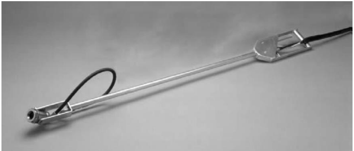
Figura 1. Lanceta de inflado de pernos, diseñado por Atlas Copco para la instalación convencional de pernos Swellex.
