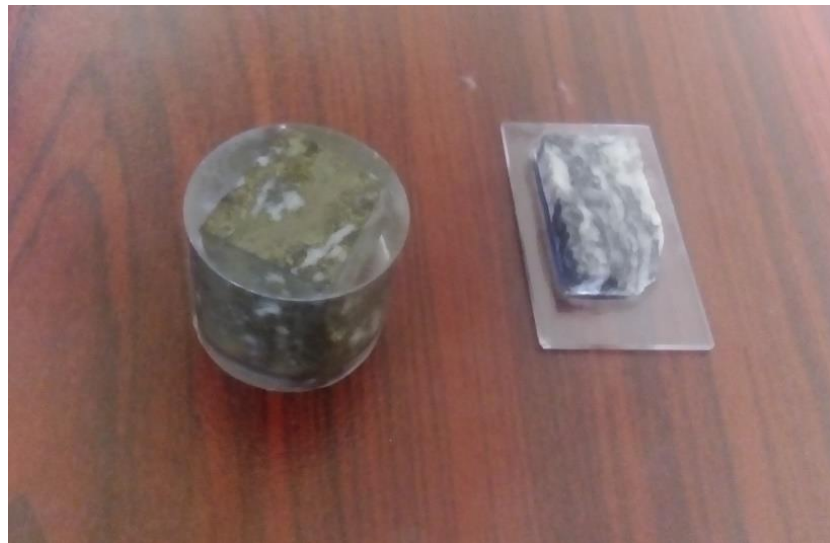
Figura 14. Elaboración de secciones pulidas y secciones delgadas, antes de pasar los abrasivos.
