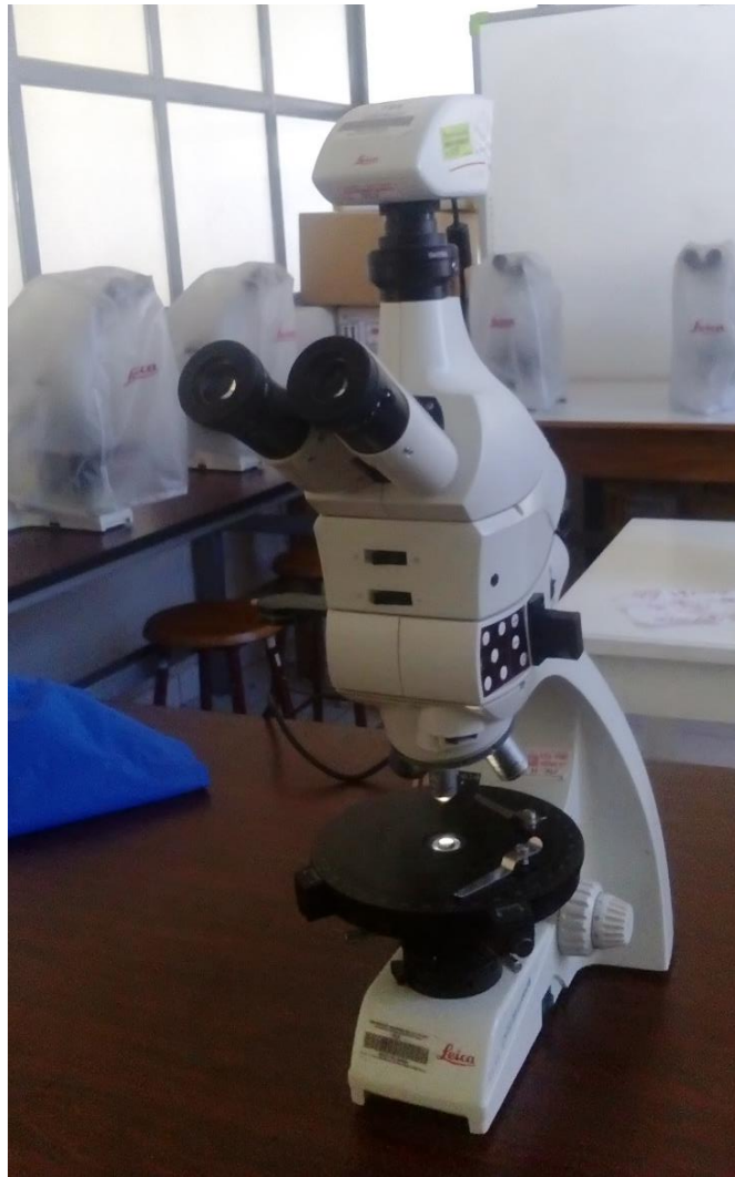
Figura 15. Microscopio petrográfico, marca Leica, serial DM 750P.
