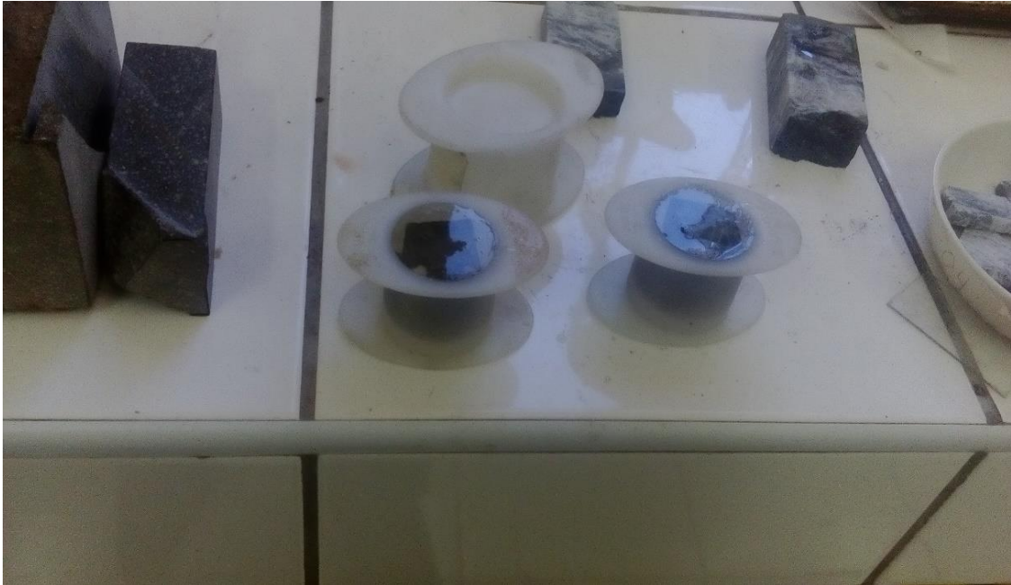
Figura A.3. Moldeado con resina para secciones pulidas
