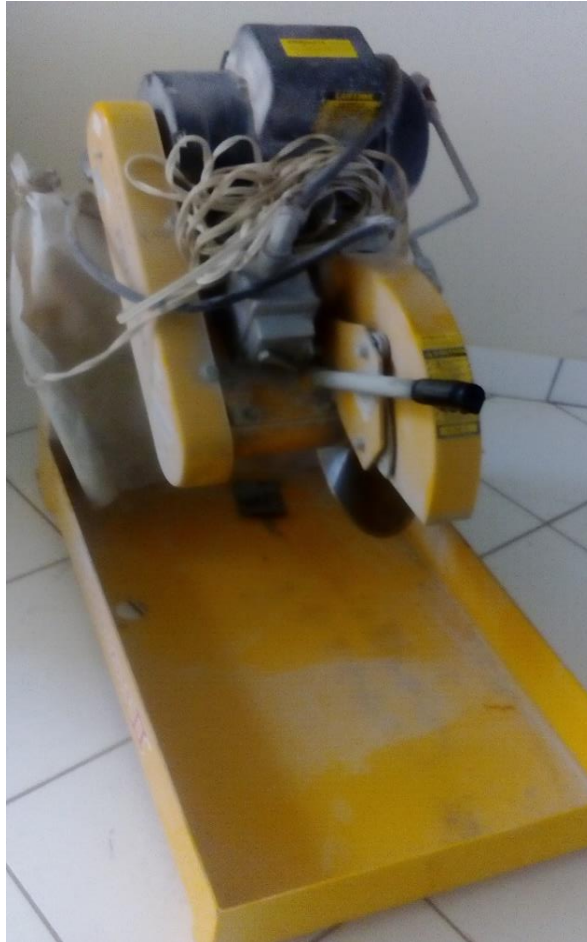
Figura. A.1. Cortadora de roca, marca FELKER, de disco continuo adiamantada, que se corta con refrigeración de agua
