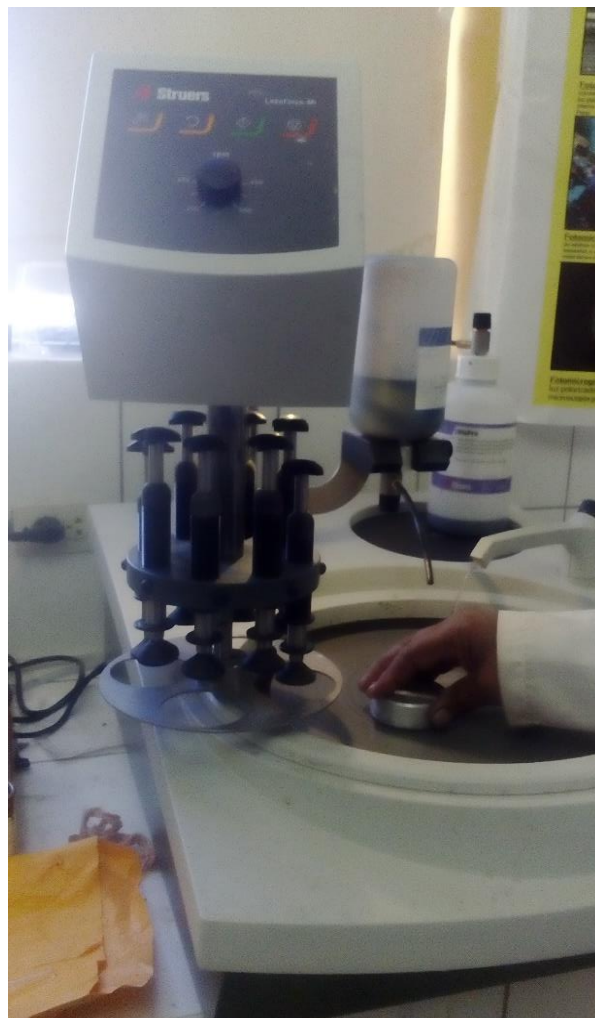
Figura A.4. Desgastadora de marca Struers, para realizar las secciones delgadas y secciones pulidas, se aplica abrasivos y agua con diferentes mallas (Nº de mallas)
