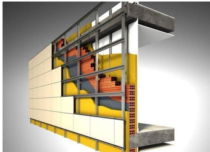
FIGURA 48: Detalle de Fachadas Colectoras
