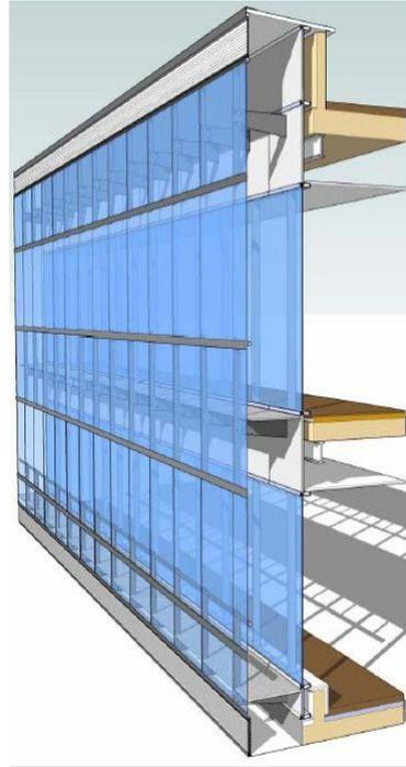
FIGURA 50: Muro cortina con vidrios Fotovoltaicos en Fachada
