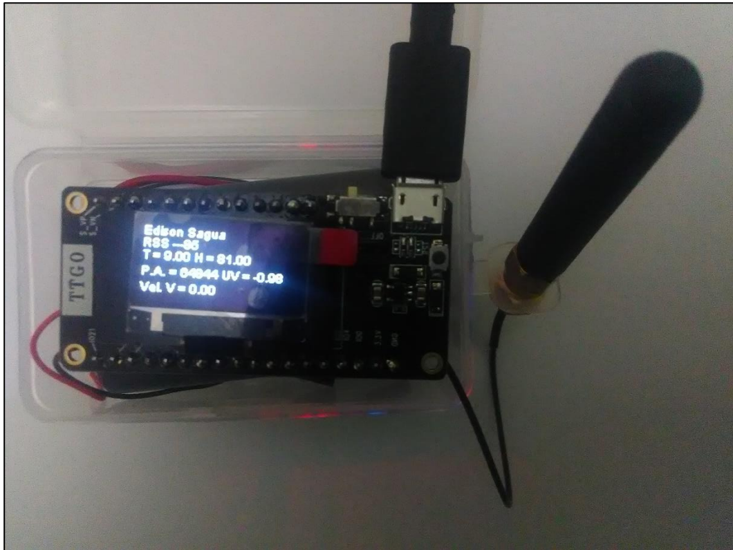
Figura 27: Dispositivo esclavo TTGO LORA32 V2.0.
