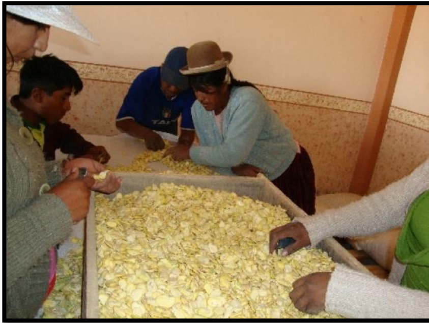
Imagen 3: Proceso de selección de haba pelada por calibres en planta de transformación
