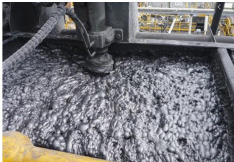
Figura 10: Espumación de minerales
