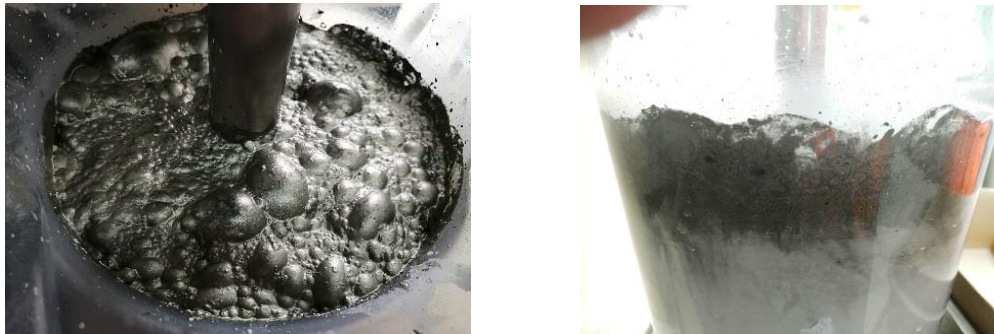
Figura 23: Celda de flotación arenas
