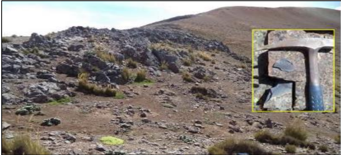
Figura 6: Andesitas intensamente diaclasadas y meteorizadas en el tajo Corihuarmi.
