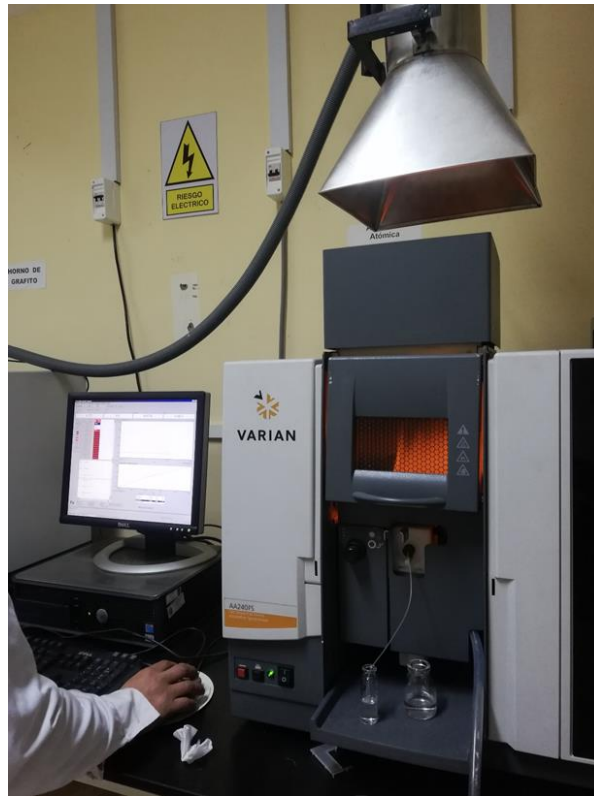
Fotografía 12. Análisis de Minerales por Espectrofotometría de Absorción Atómica
