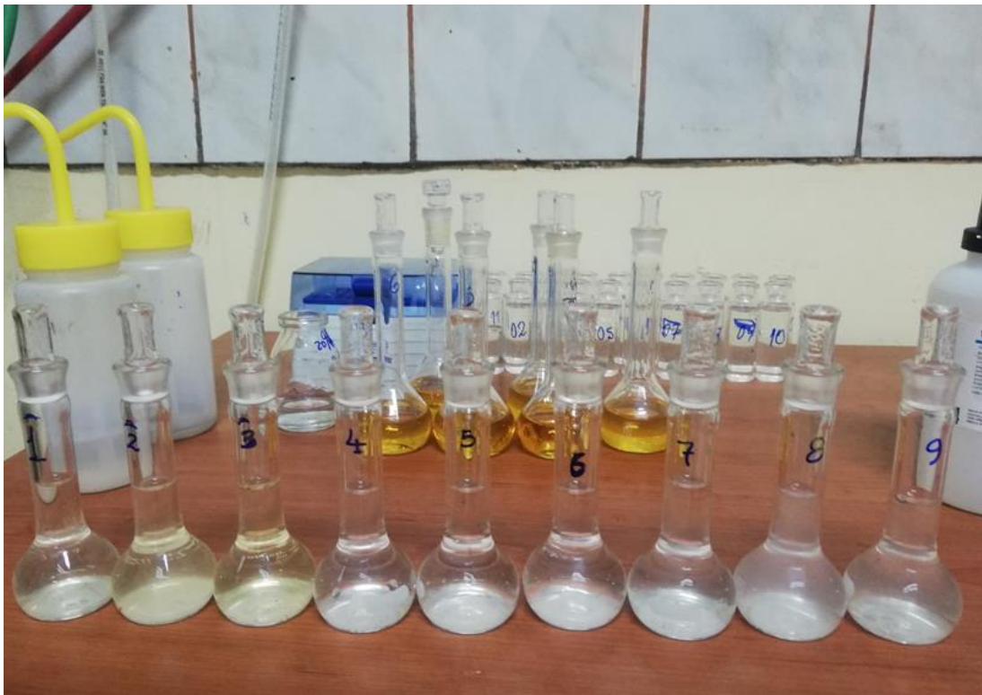
Fotografía 10. Proceso de digestión y muestras extraídas para análisis de Minerales
