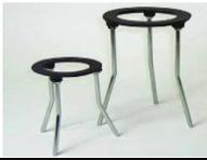
La finalidad que cumple el trípode de laboratorio es solo una. Este es utilizado principalmente como una herramienta que sostiene la rejilla de asbesto.
