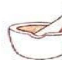
Son utensilios hechos de diferentes materiales como: porcelana, vidrio o ágata, los morteros de vidrio y de porcelana se utilizan para triturar materiales de poca dureza y los de ágata para materiales que tienen mayor dureza.
