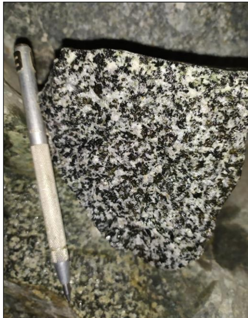
Figura 21. Muestra de mano de roca granodiorita con biotita extraída de la zona de estudio
