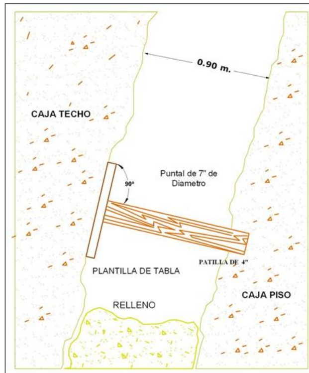
Figura 11. Sostenimiento en Tajeos.
