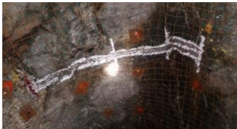
Figura 25: Toma de muestras gemelas. (Manual de muestreo geológico Minsur, 2019).
