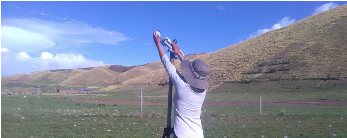
Fotografía 2: Medición de presión de trabajo del aspersor en evaluación.
