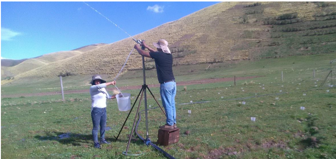
Fotografía 1: Cálculo de descarga del aspersor, mediante el método volumétrico.
