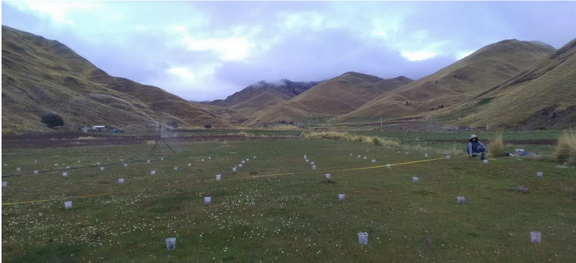
Fotografía 4: Colocación envases pluviométricos en red de 2.5x2.5m.
