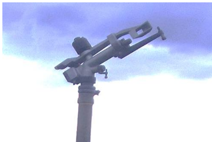
Figura 14: Aspersor de riego con conexión rosca hembra de 1 ¼" con doble boquilla (10.0 mm x 4.0 mm).
