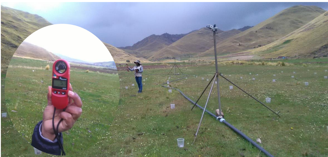
Fotografía 3: Obtención de datos velocidad de viento, humedad relativa, temperatura in situ, mediante el anemómetro portátil.
