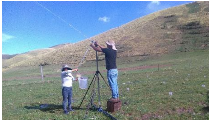
Figura 17: Medición de la descarga del aspersor.
