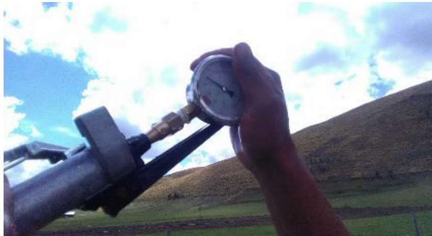
Figura 16: Medición de la presión.
