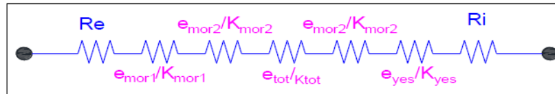
Figura 27: Representatividad de las diversas capas en un circuito térmico.
