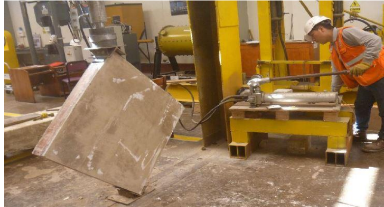
Figura 23: Ensayo de resistencia diagonal de un panel de 0.90 m.× 0.90 m.
