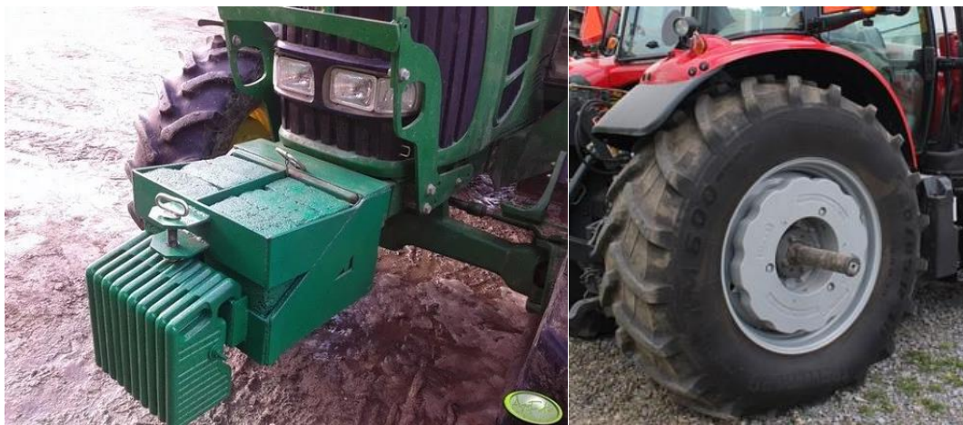
Figura 4. Lastrado voladizo delantero (izquierda) y Contrapeso en aro trasero (derecha)
