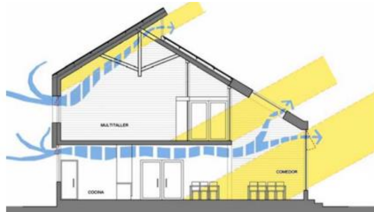
Figura 2. 2. Estrategias de captación solar directa según zona climática.
