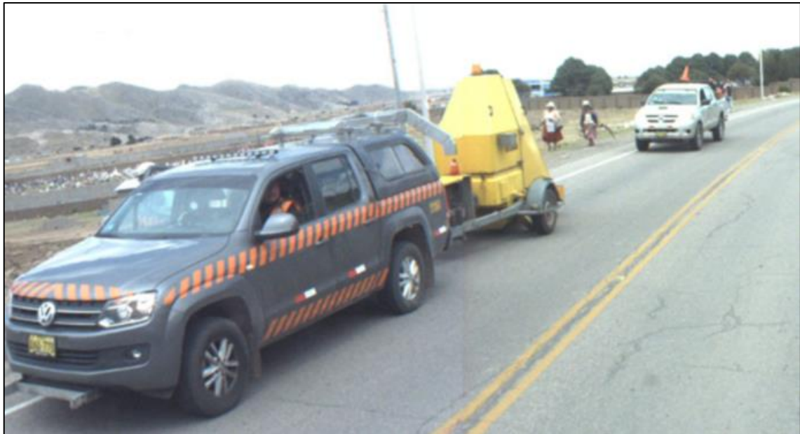
Figura 47. Mediciones de deflectometría
