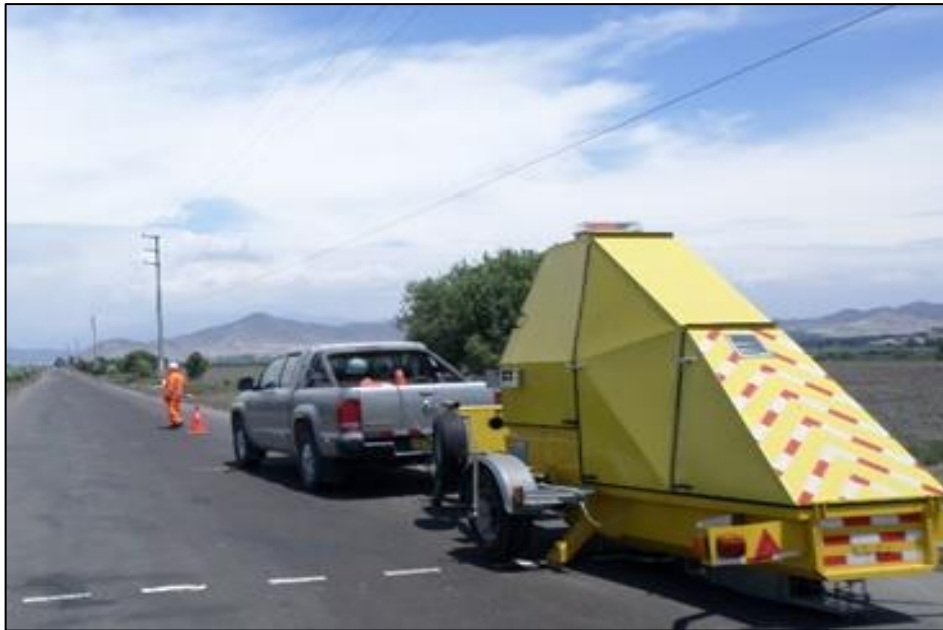
Figura 18. Ensayos no destructivos (FWD)
