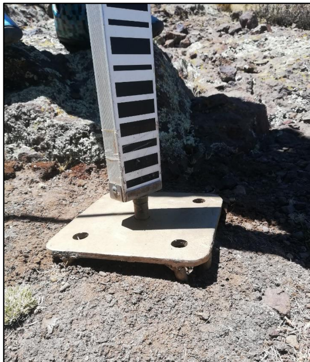
Figura 56: Placa de Apoyo para Puntos de Cambio
