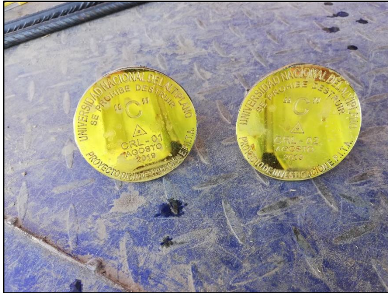
Foto N°01: Placas, Puntos Geodésicos CRL – 01 y CRL – 02.
