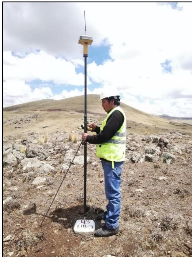
Fotografía N° 13: Grabado de Datos del Punto CRL – 03
