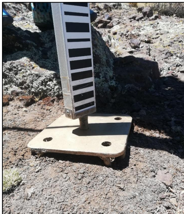
Fotografía N° 16: Placa de Apoyo para Puntos de Cambio Conocido
