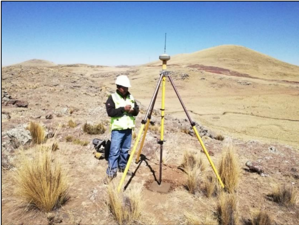
Figura 28: Obtención de Altitudes de los puntos de control Mediante el GPS Diferencial GR5
