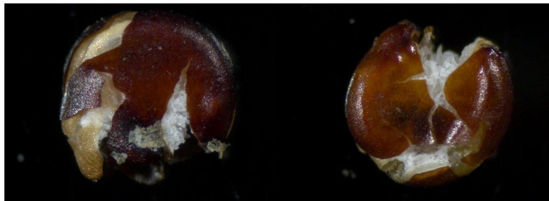
Fig. D.1: Daño mecánico ocasionado por la aplicación de fuerza externa a granos de la variedad Ramis con 20 % de humedad b.s. promedio.
