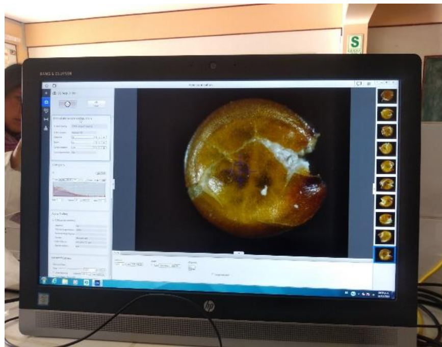
Fig. E.9: Observación de daño mecánico producido por la aplicación de fuerza externa.
