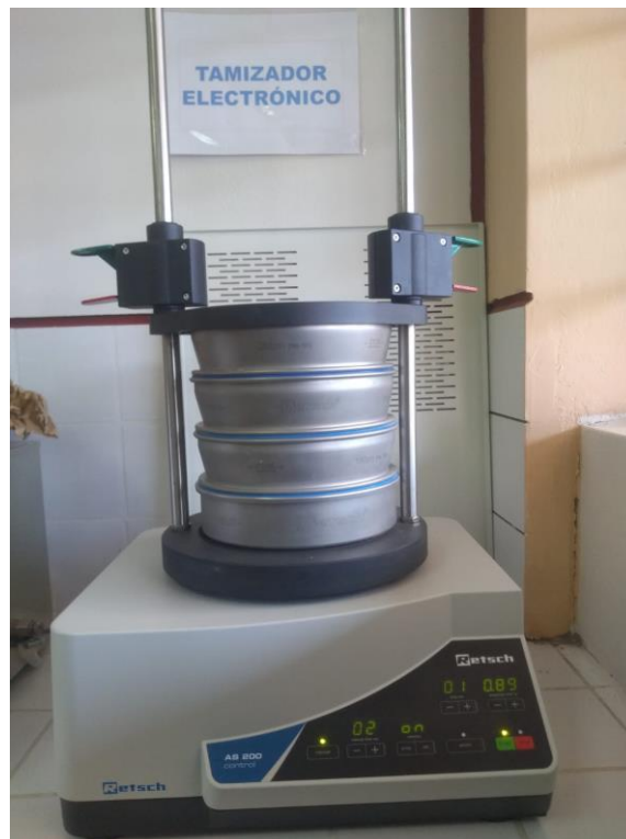
Fig. F.2: Tamizador electrónico para obtener partículas de diferentes tamaños.
