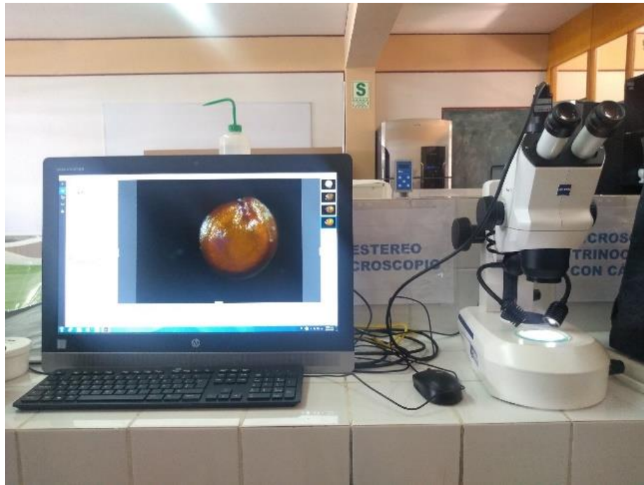
Fig. E.9: Estereomicroscopio para la adquisición de imagen.
