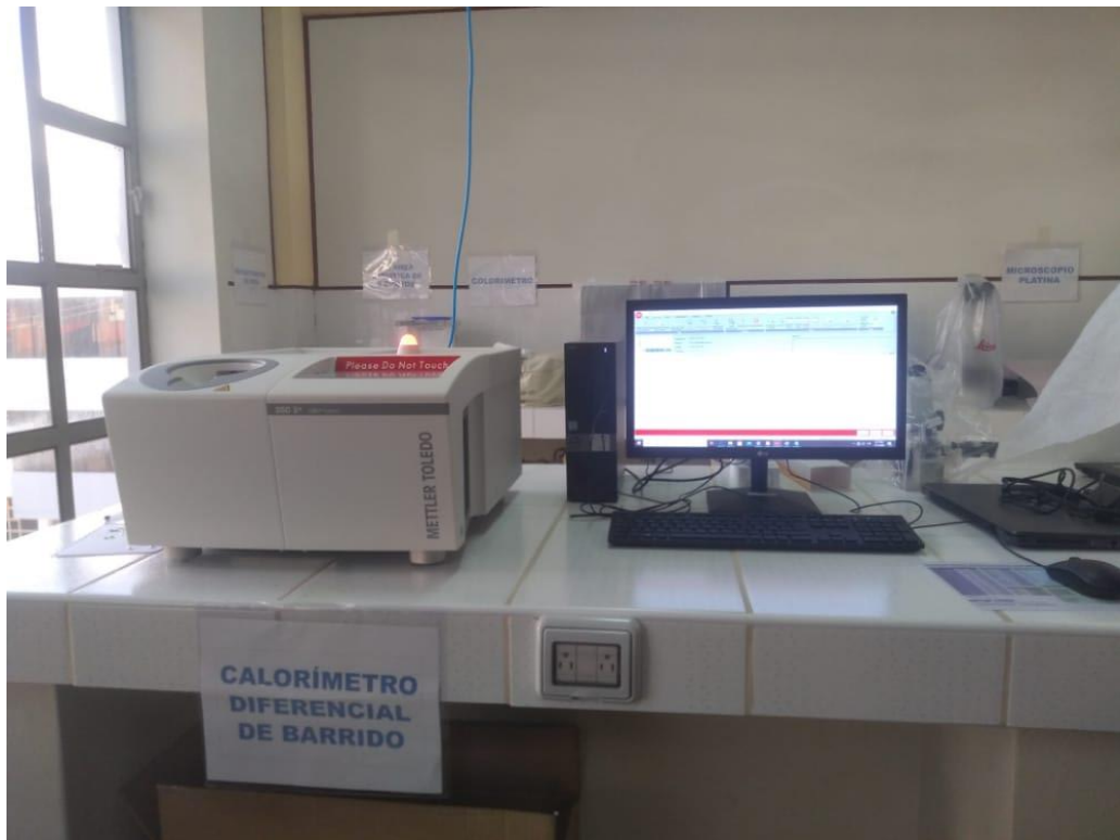
Fig. F.8: Análisis de las propiedades termales en el equipo calorímetro diferencial de barrido (DSC)
