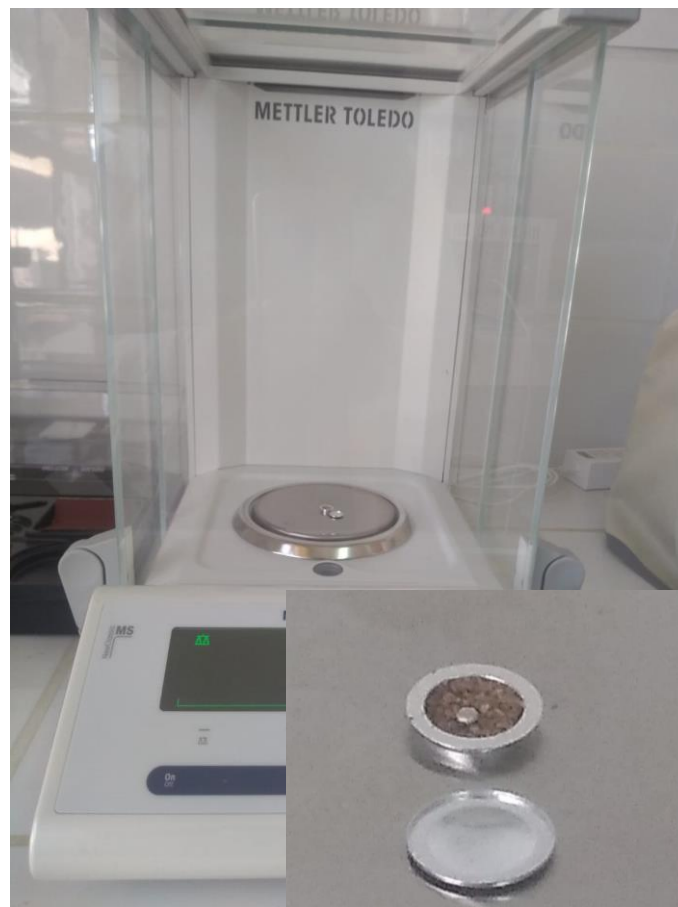
Fig. F.4: Microbalanza utilizada para pesar las muestras
