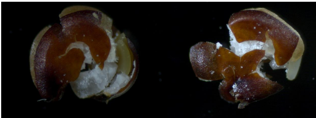
Fig. D.1: Daño mecánico ocasionado por la aplicación de fuerza externa a granos de la variedad Illpa-INIA con 10 % de humedad b.s. promedio.
