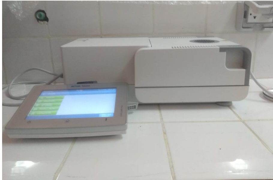
Fig. F.3: Balanza de humedad para la determinación de humedad de harina de cañihua.
