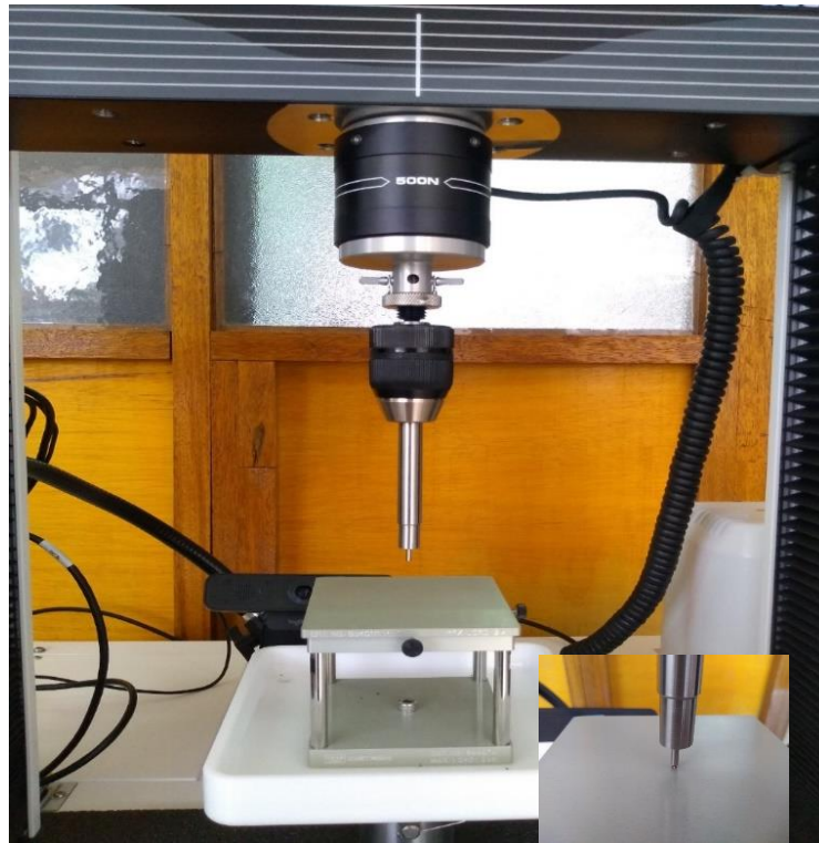
Fig. E.7: Equipo texturómetro INSTRON preparado para las pruebas de compresión en los granos individuales.
