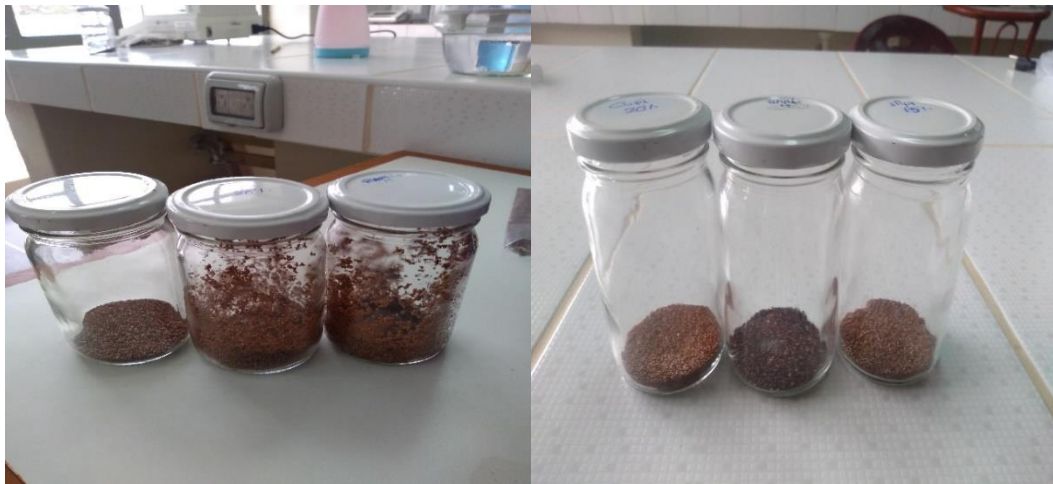
Fig. E.2: Acondicionamiento de humedad (15% y 20%) para las pruebas de compresión.
