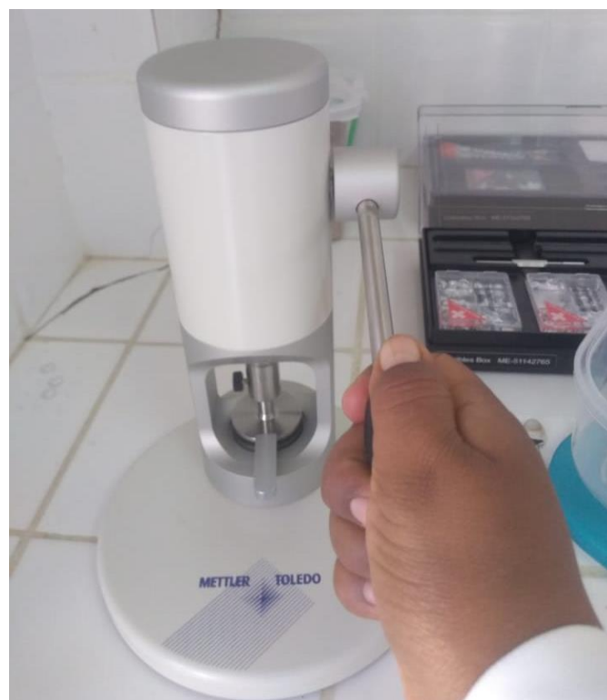
Fig. F.7: Soldado en frío de los crisoles de aluminio de 40 \mu l.
