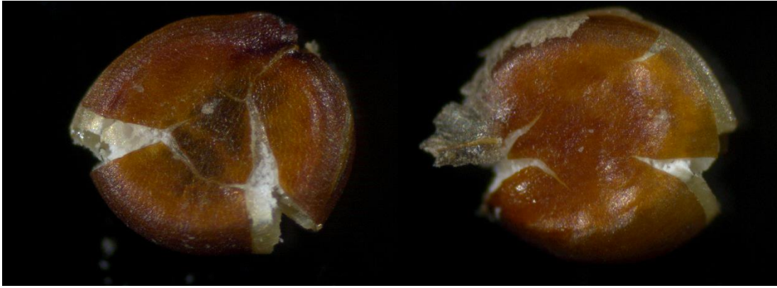
Fig. D.1: Daño mecánico ocasionado por la aplicación de fuerza externa a granos de la variedad Cupi con 20 % de humedad b.s. promedio.
