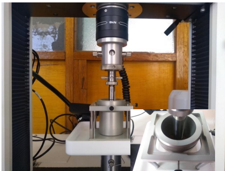
Fig. E.8: Equipo texturómetro INSTRON preparado para las pruebas de compresión en los a granel.
