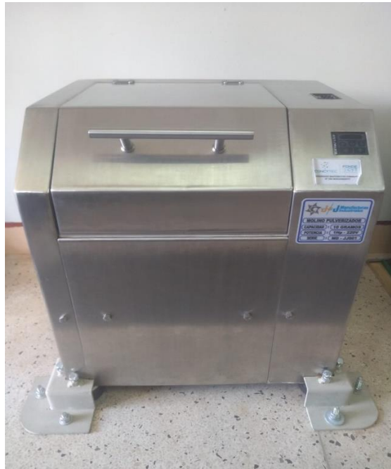
Fig. F.1: Molino de anillos de 10 gramos de capacidad utilizado para la molienda de granos de cañihua
