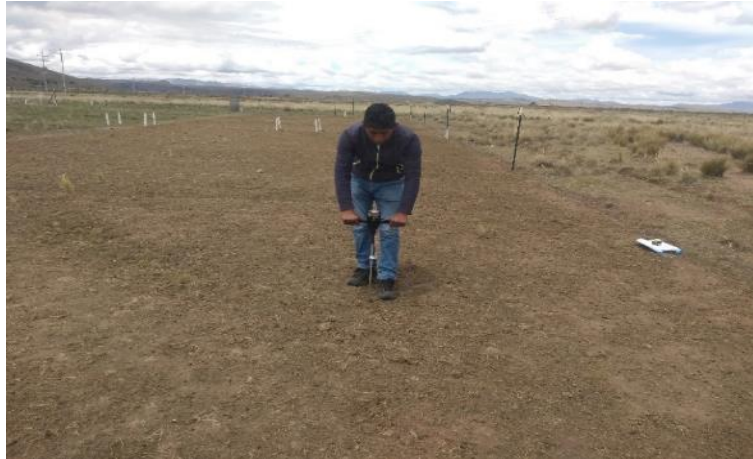
Foto 7. Prueba de compactación después de realizar el dormidero de ovinos durante tres noches
