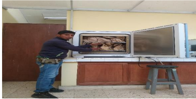
Foto 10. Colocado de muestras en estufa eléctrica a 65 °C por 48 horas
