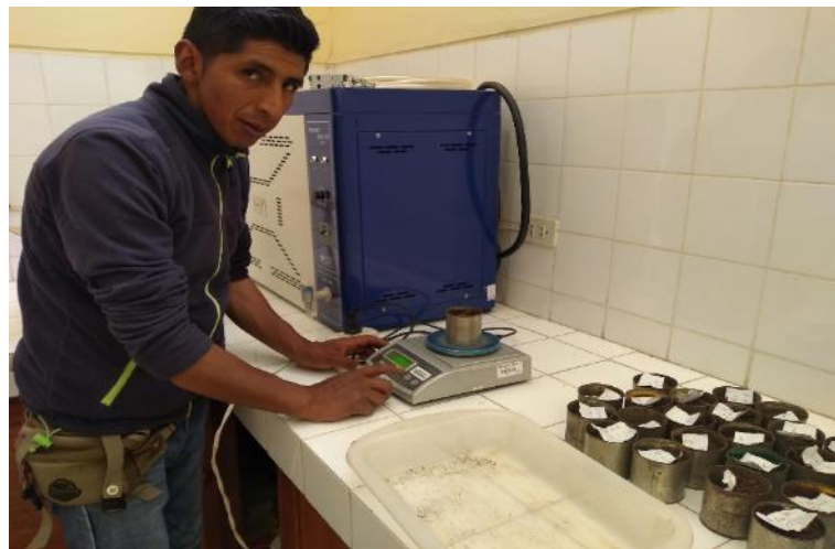
Foto 12. Pesado de muestras de suelo para determinar la humedad del suelo
