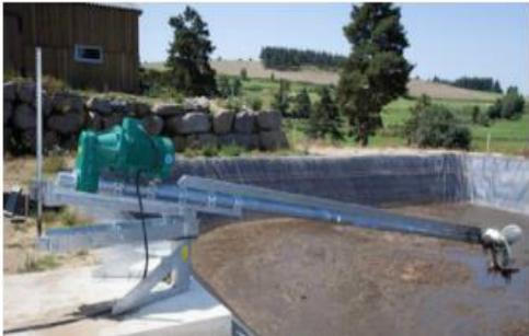
**Figura N° 4.4: Agitadores / mezclador de tanque de alimentación**
