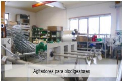
Agitadores para biodigestores
