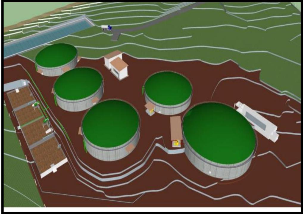
**Figura N° 3.2: Muestra de los lechos de secado de lodos, cuatro biodigestores y un tanque de mezclado**
