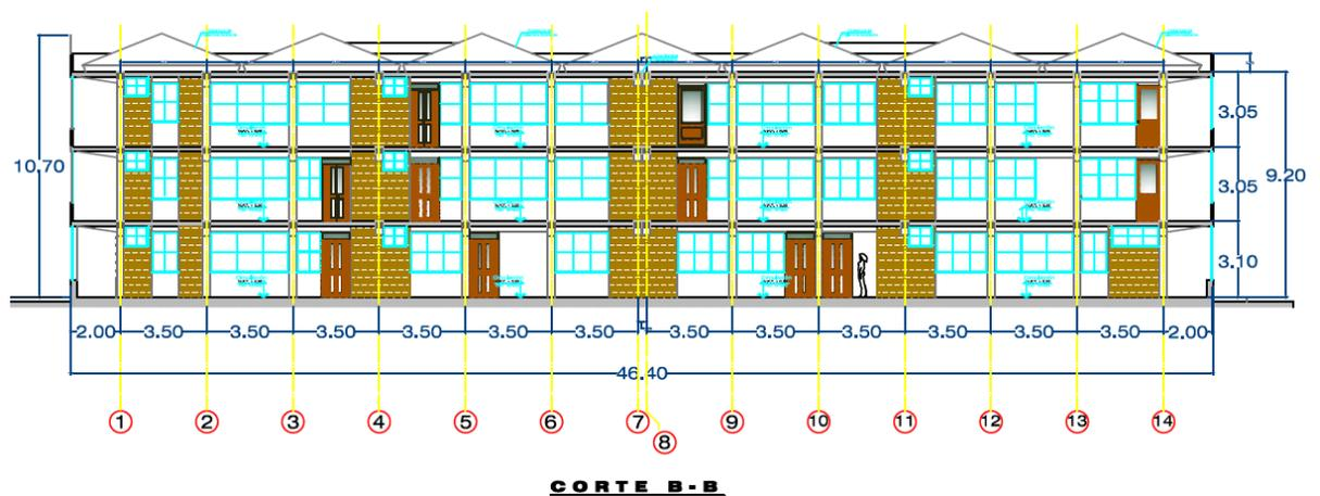
Figura 3.2 Elevación en dirección Norte-Sur del edificio de Ciencias Físico Matemáticas (dimensiones en metros)
