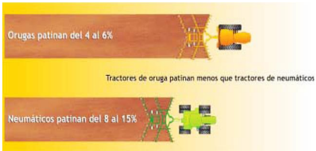
Figura 4. Compactación por patinaje
