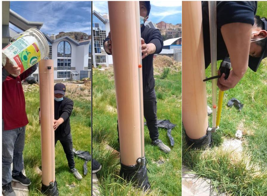
FOTO N° 20: prueba de permeabilidad del concreto.
