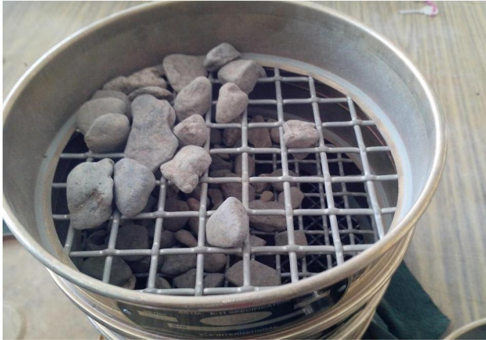
FOTO N° 07: Muestra de agregados que sé que queda en la malla correspondiente.
