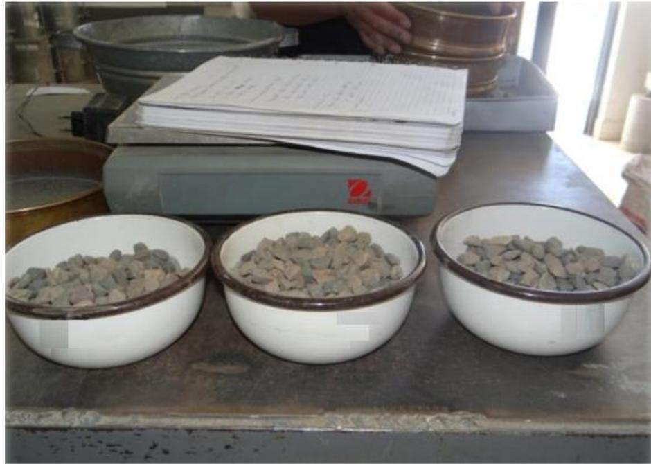
FOTO N° 05: Muestra de agregados para la gravedad específica y absorción.
