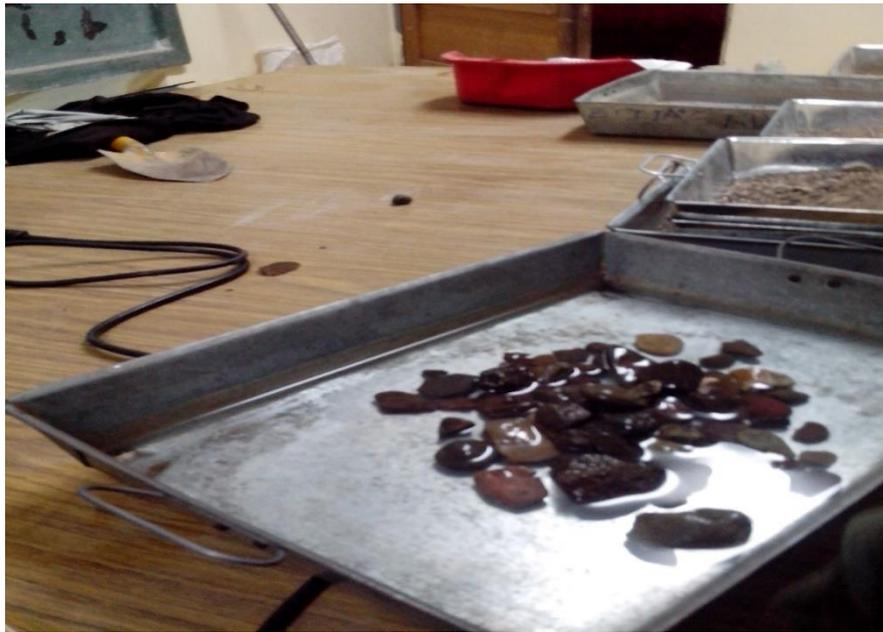
FOTO N° 11: Muestra de agregado grueso con agua en una bandeja.
