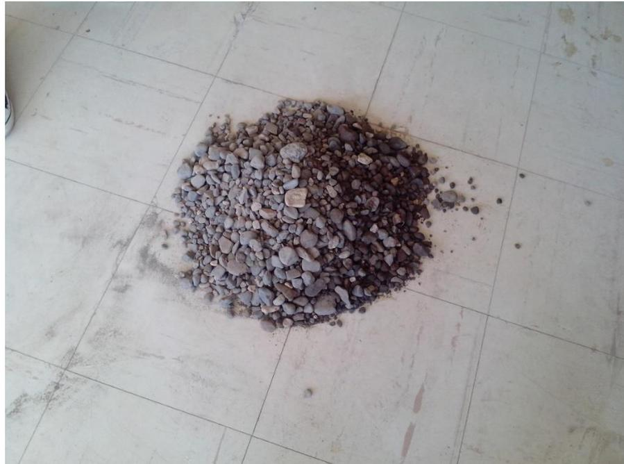
FOTO N° 01: Muestra del agregado grueso.
