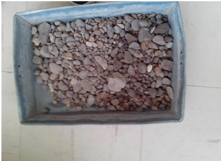
FOTO N° 08: Muestra de agregados seleccionado por las mallas.
