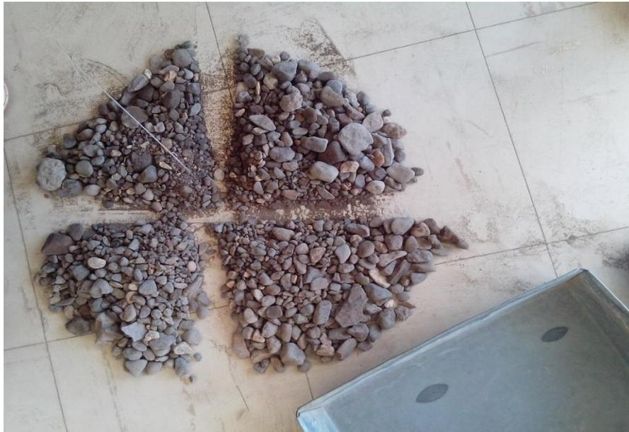
FOTO N° 09: Muestra de agregados grueso cuarteado.
