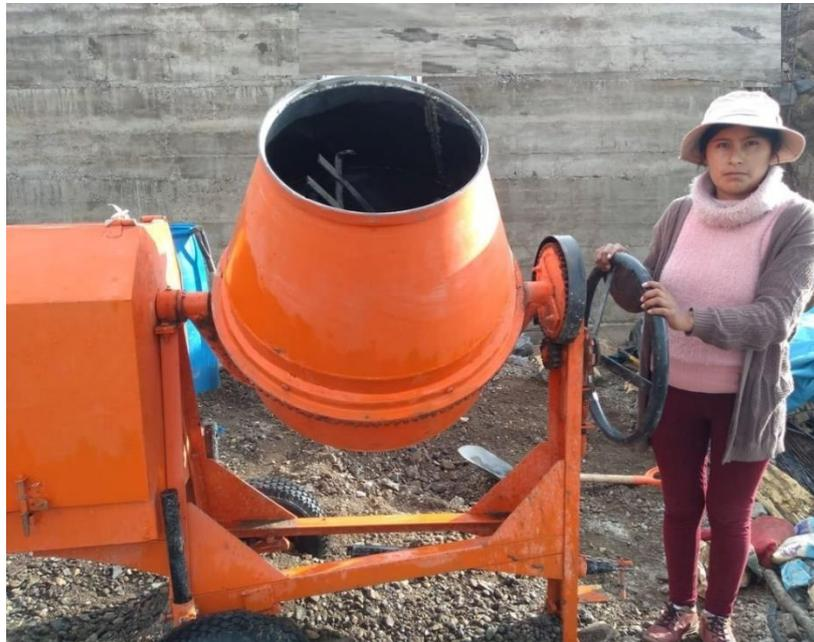
FOTO N° 18: Muestra de trompo manual para obtener la mezcla del concreto permeable.
