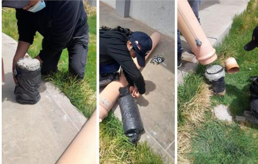
FOTO N° 19: preparación de muestras y colocado del permeámetro.
