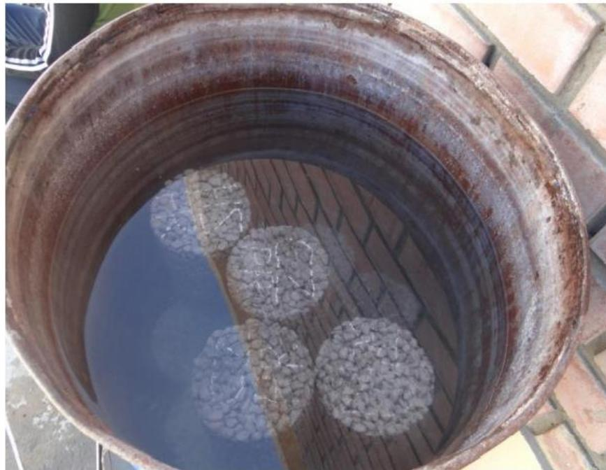
FOTO N° 12: Probetas desmoldadas y en proceso de curado.
