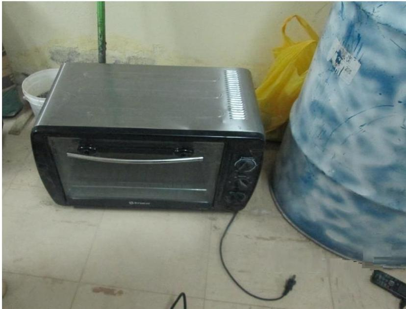
FOTO N° 15: Muestra de microondas para el secado del agregado.
