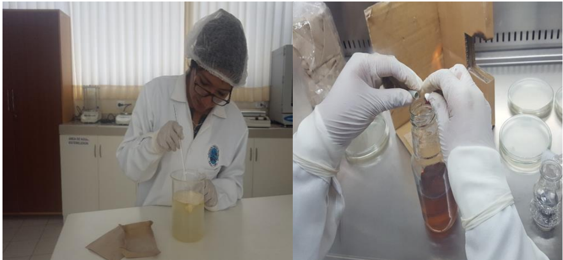
Figura 18. Preparación del medio de cultivo PDA, autoclavado a 180°C por 20 minutos, y adición de 1gr de cloranfenicol.
