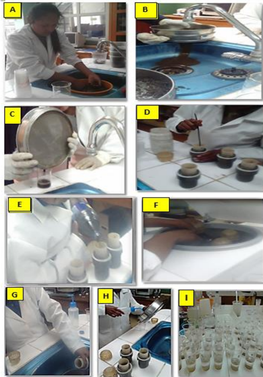
Figura 7. (A) Homogenización de la muestra, (B) Tamizado de suelos, (C) Recolección de muestra, (D) Tubos con caolín, (E) Incorporación de sacarosa, (F) Tubos para la centrifugación (G) Eliminación del sobrenadante, (H) Recolección de muestras, (I) Muestras para
