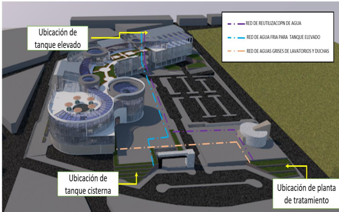
Figura 122: Ubicación de tanques elevados
