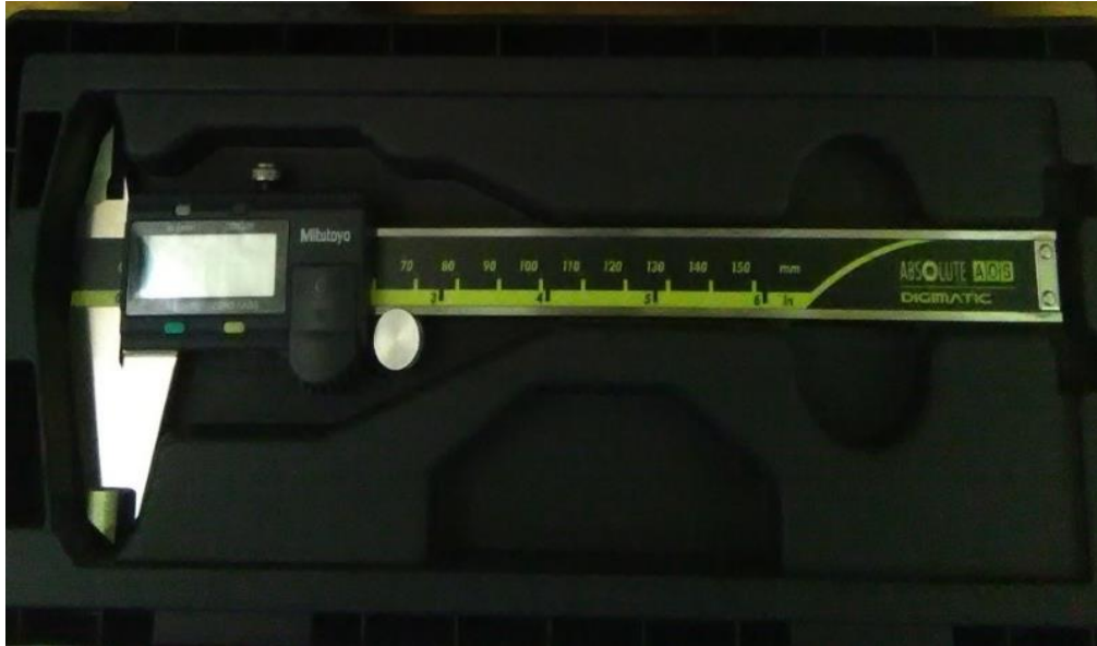
Figura 4. Instrumento para tomar medidas (Calibrador Mitutoyo)
