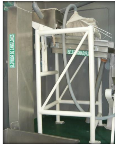
Figura 73. Máquina Elevadora de Cangliones – Proceso de Limpieza. Fuente: Desaponificado, Selección y Clasificado de Granos Andinos (s.f.).
