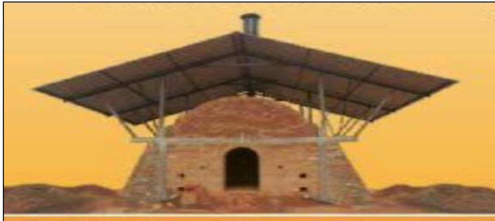
Figura 16: Horno de tiro invertido. Fuente, Programa EELA de swiss contact.
