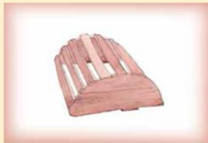
Estructura para construir el arco del ducto de evacuación de gases
