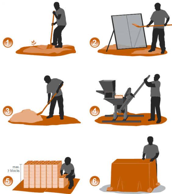
Figura 21 Pasos para la elaboración de ladrillos modulares de tierra comprimida.
