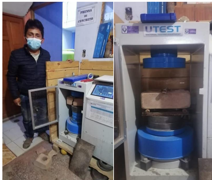
Figura 44 Ensayo a la flexión de primas de albañilería
