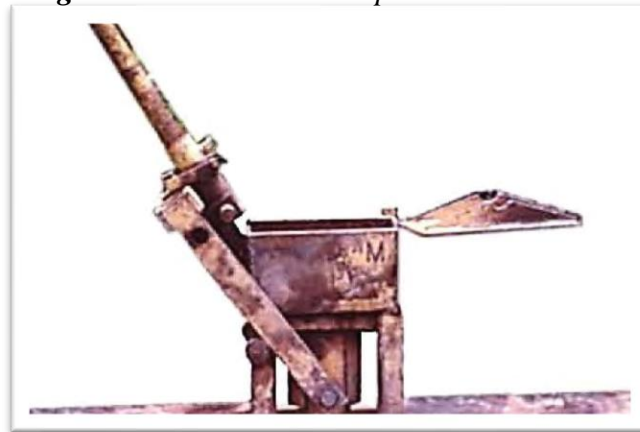
Figura 4 Primer molde de prensa CINVA Ram
