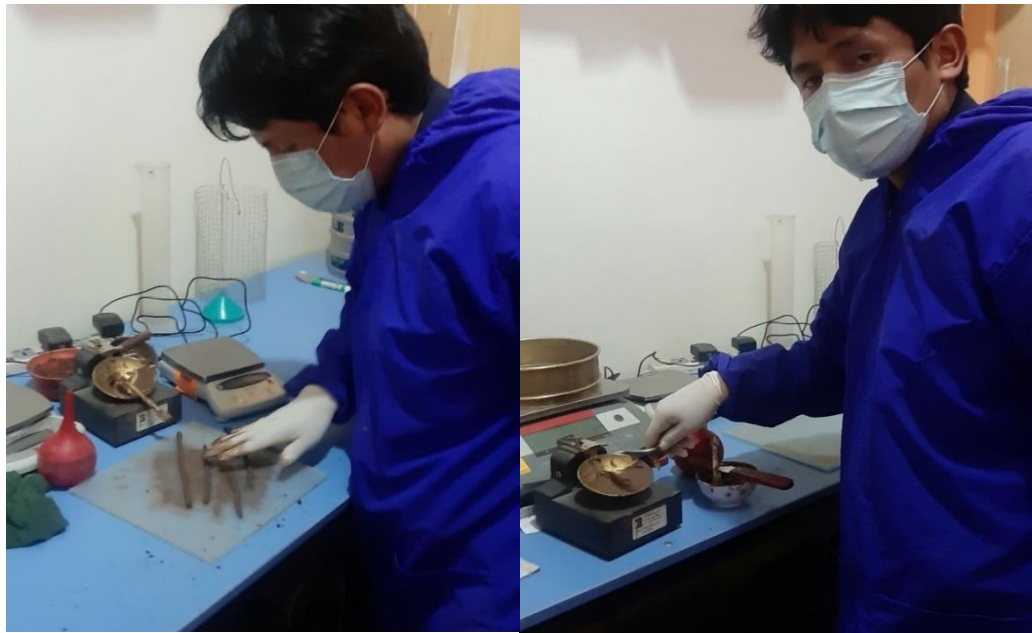
Figura 36 Ensayos para determinar los límites de consistencia del suelo base
