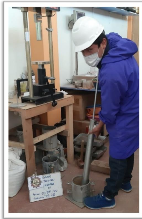
Figura 38 Ensayo de compactación próctor estándar de suelo base.
