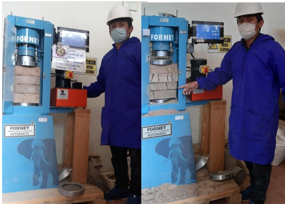
Figura 46 Ensayo de compresión de prismas en laboratorio
