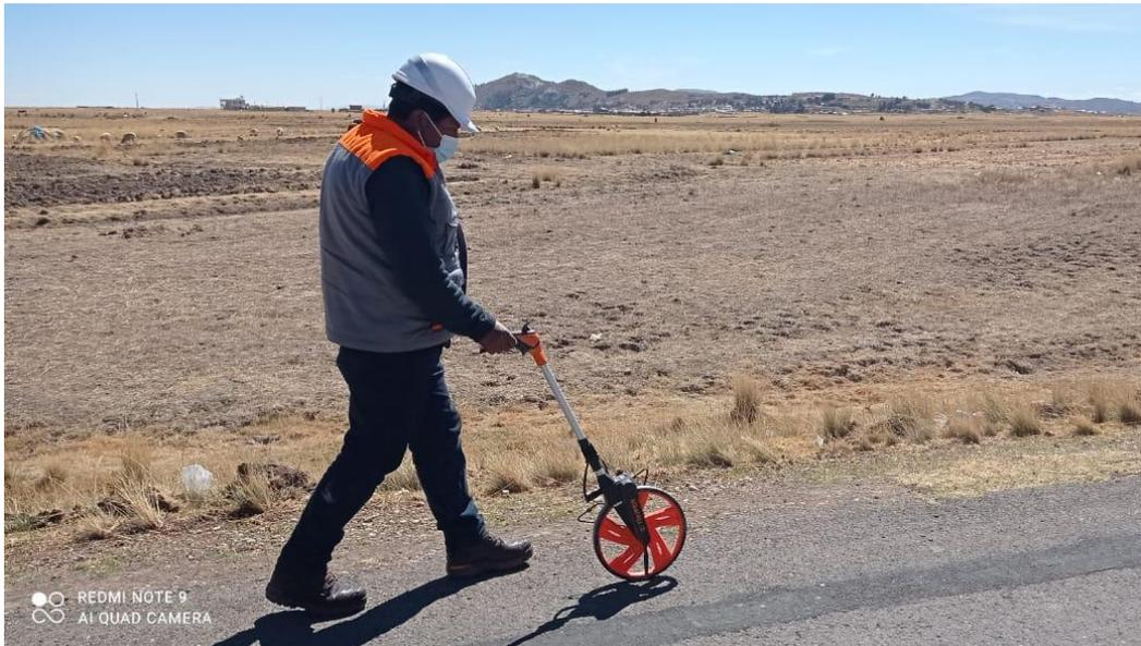
*Figura 37.* Medición de distancia con Odómetro digital
