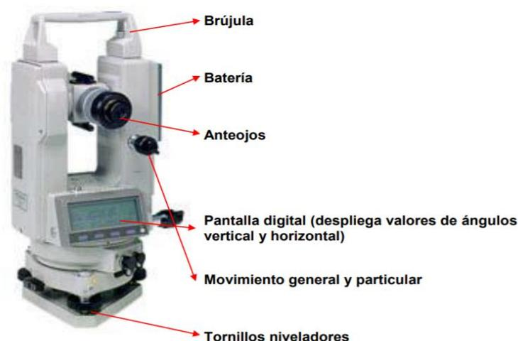
Figura 7. Operación del teodolito
