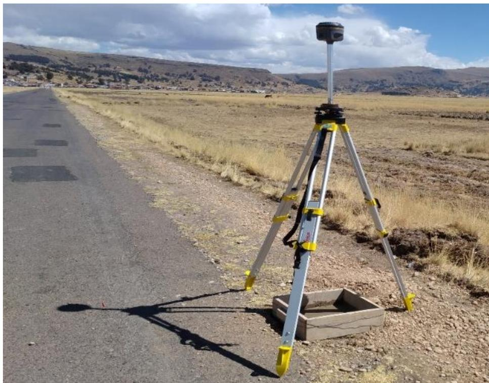
*Figura 29.* Obtención de coordenadas de los puntos de control con el GPS
