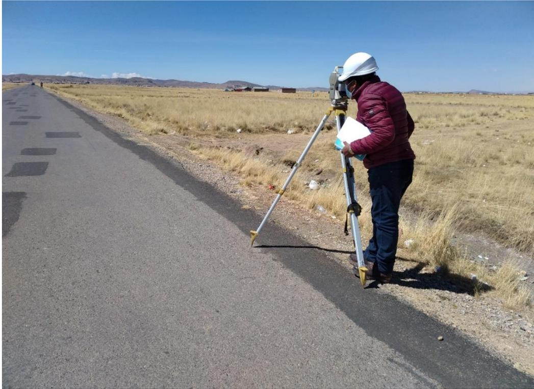
*Figura 36.* Medición de distancia con Teodolito electrónico Nikon
