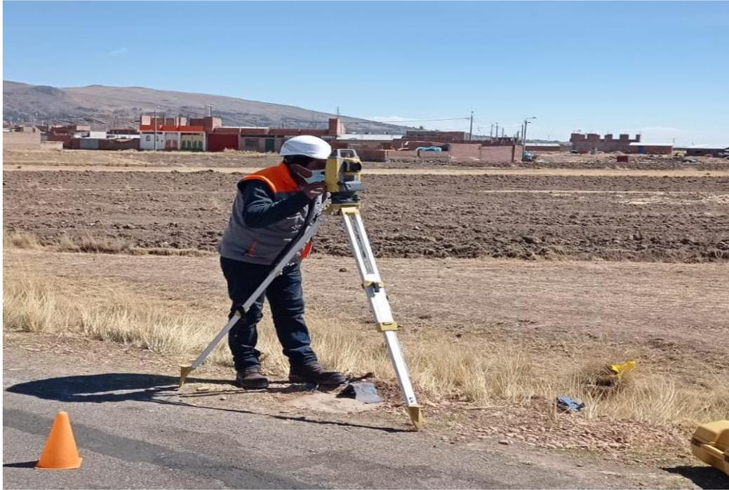
*Figura 38.* Medición de distancia con Estación Total Topcon
