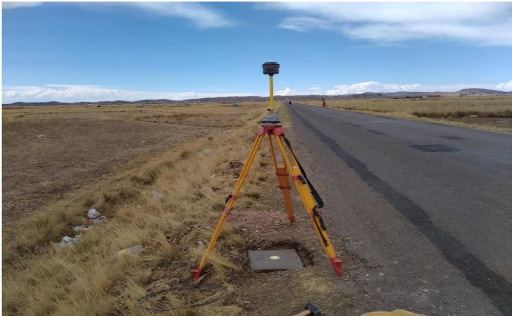
*Figura 35.* Instalación de puntos de control geodésicos PCG-02
