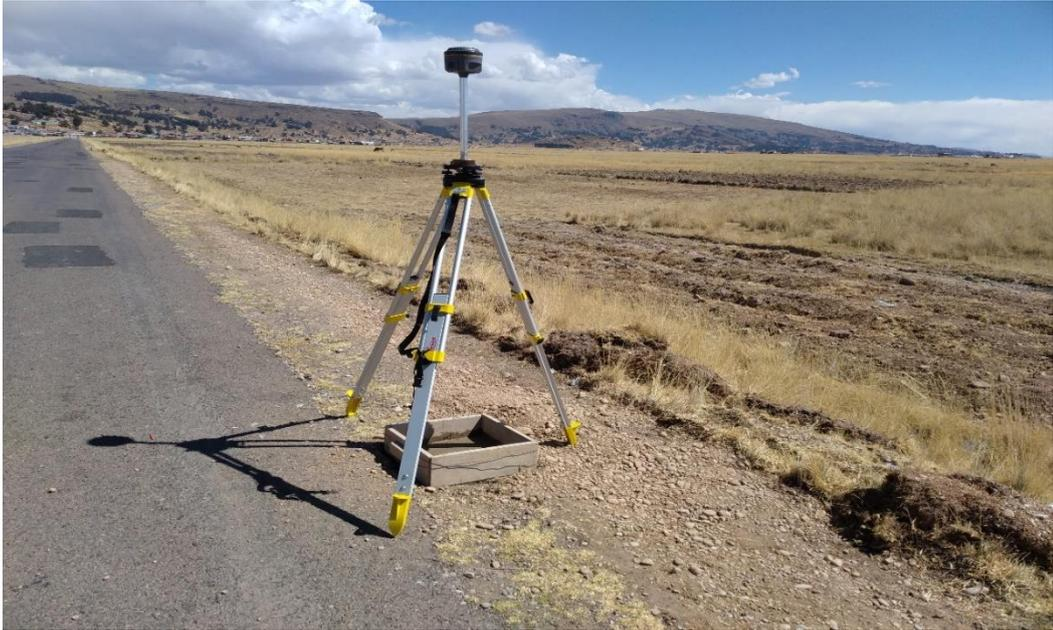
*Figura 34.* Instalación de puntos de control geodésicos PCG-01
