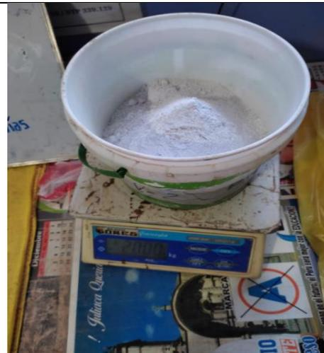
**Figura 97:** Mortero Cemento- Yeso peso 1:1 (anexos).
