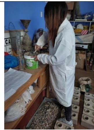
**Figura 100:** Mezcla finalizada y homogeneizada (anexos).
