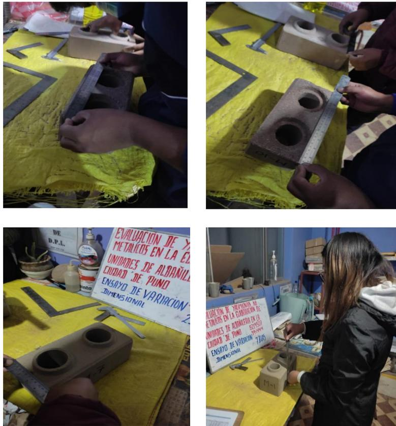
**Figura 21:** Ensayo de variación dimensional-medida altura, ancho y largo
