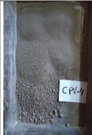
**Figura 61:** Resultados granulométricos muestra CPV – 04 (anexos).
