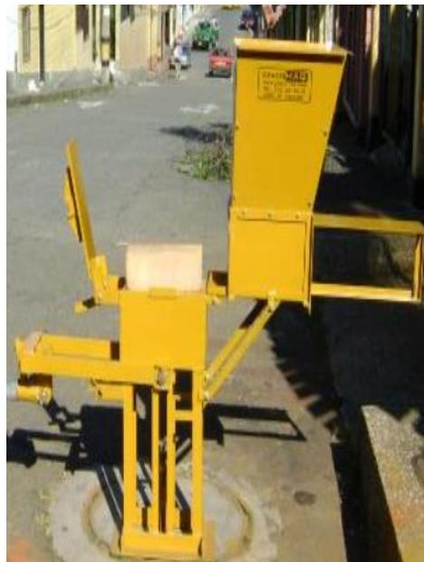
**Figura 8:** Máquina moldeadora CINVA-RAM.
