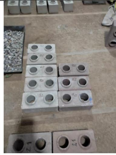
**Figura 90:** Se procede a clasificar por días de secado y curado (anexos).
