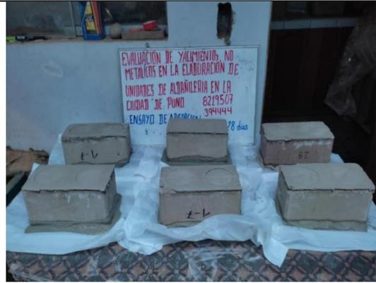
**Figura 107:** Mortero de lado contrario para su nivelación (anexos).
