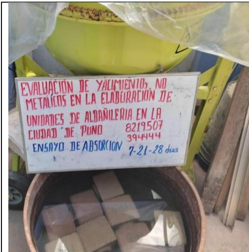
**Figura 94:** Unidades sumergidas por 5 horas (anexos).
