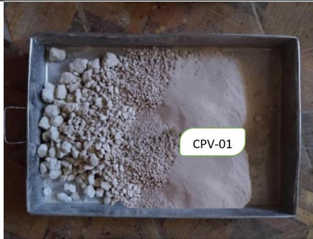
**Figura 58:** Resultados granulométricos muestra CPV – 01 (anexos).
