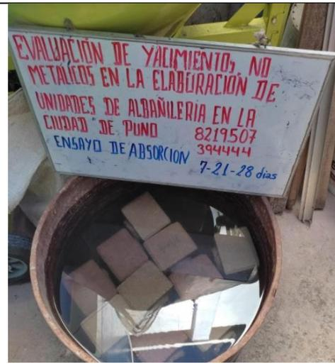
**Figura 95:** Unidades sumergidas por 24 horas (anexos).
