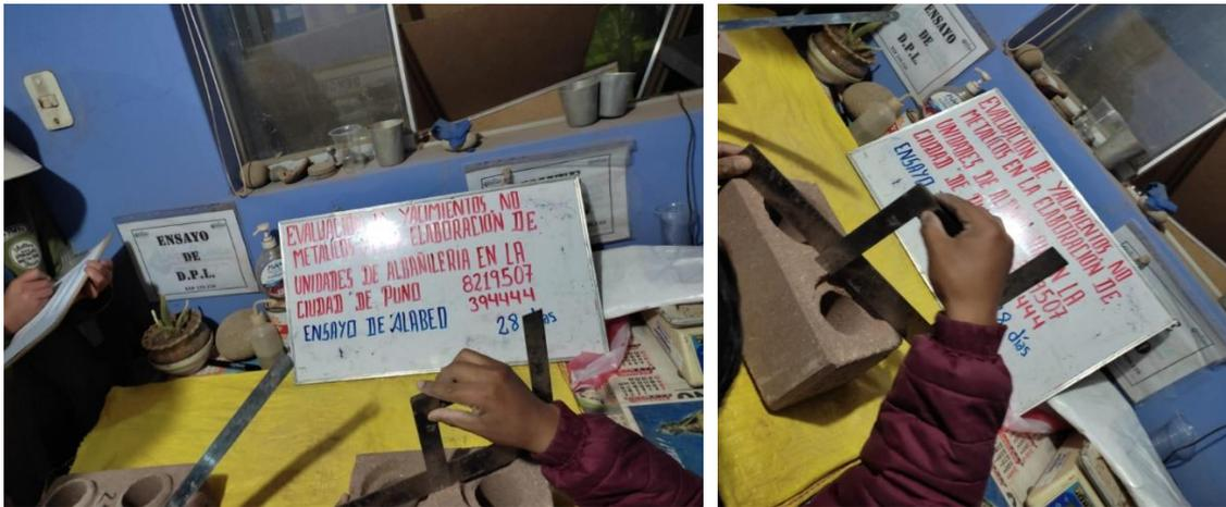
**Figura 22:** Ensayo de alabeo- reconocimiento de convexo o cóncavo
