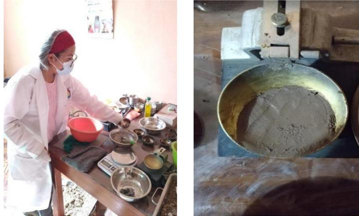
**Figura 16:** Proceso de homogeneización en copa Casagrande.
