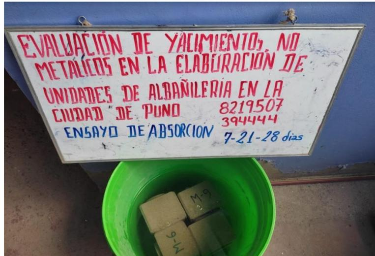
**Figura 23:** Ensayo de absorción-24 horas de sumergido la unidad.
