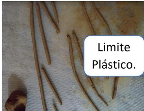
**Figura 17:** Porción de masa homogénea en rollitos de diámetro 3 mm.
