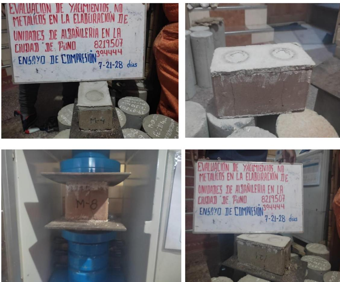
**Figura 24:** Ensayo de Resist. de Compresión – rupturas presentadas.
