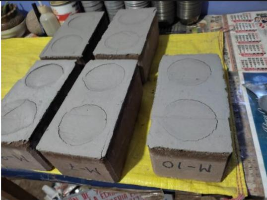
**Figura 108:** Proceso de secado de la unidad de albañilería (anexos).
