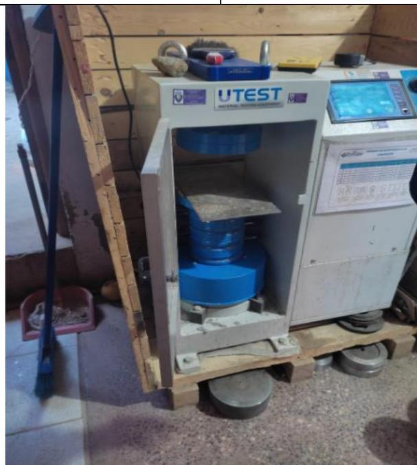
**Figura 110:** Máquina de compresión axial (anexos).
