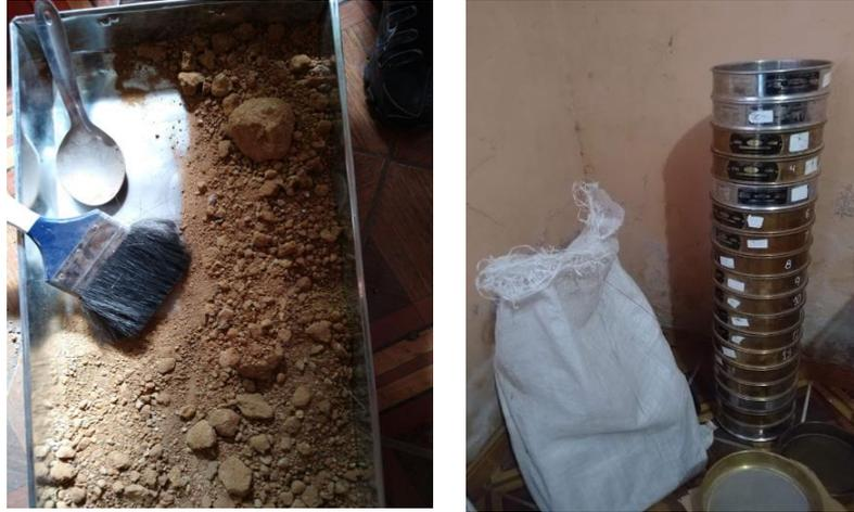
**Figura 15:** Cuarteo y tamizado de muestra.
