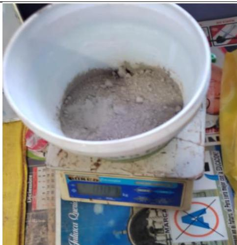
**Figura 96:** Preparado de mortero – peso del cemento (anexos).
