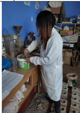
**Figura 99:** Aleación de mortero hasta una consistencia homogénea (anexos).
